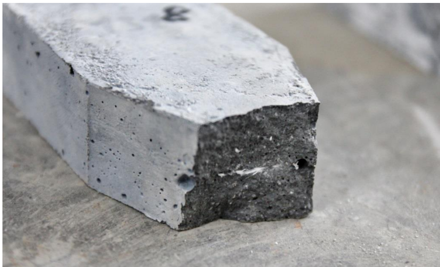
Obr. 34 - Roztržená vlákna výztuže R 131 A101
