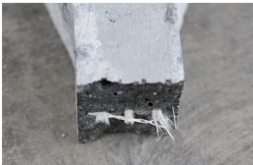
Obr. 33 - Roztržená vlákna výztuže R 275 A101
