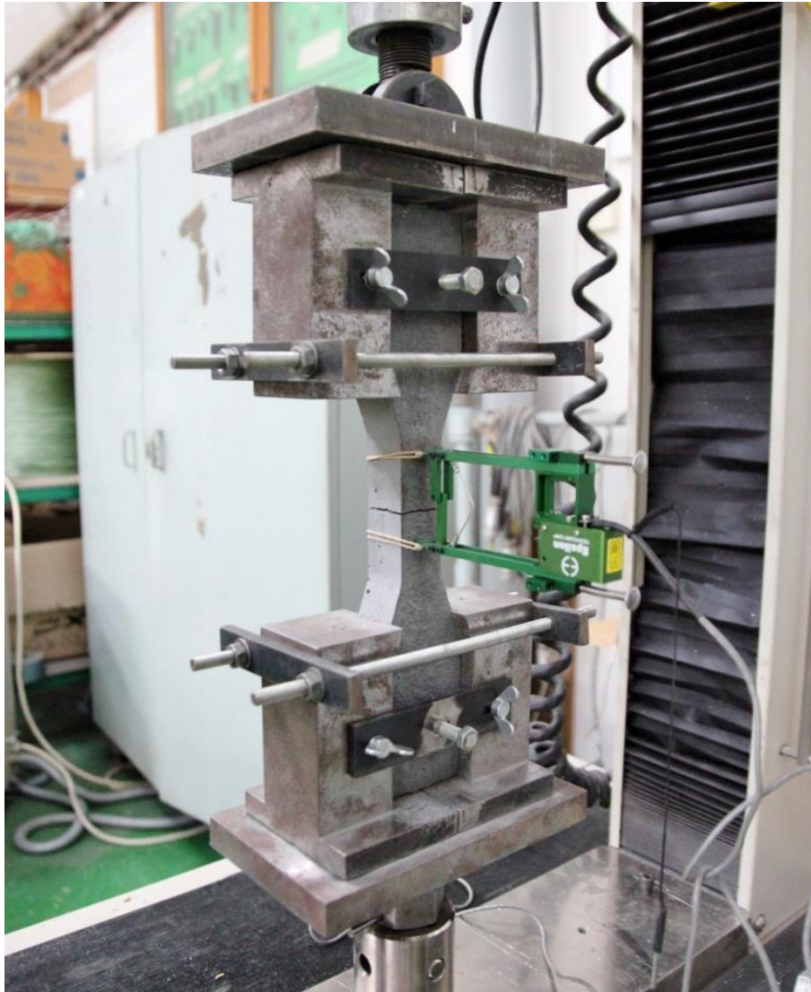
Obr. 28 - Vzorek v čelistech s extenzometrem
