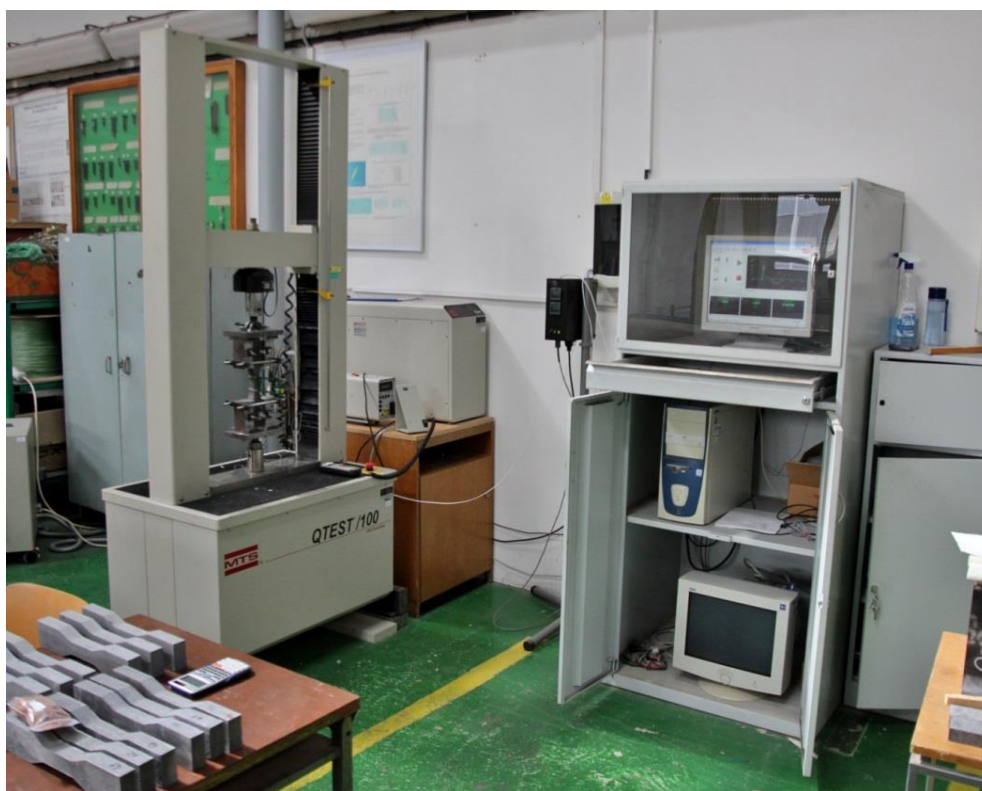
Obr. 27 - Zkušební sestava pro zkoušení dog-bone
