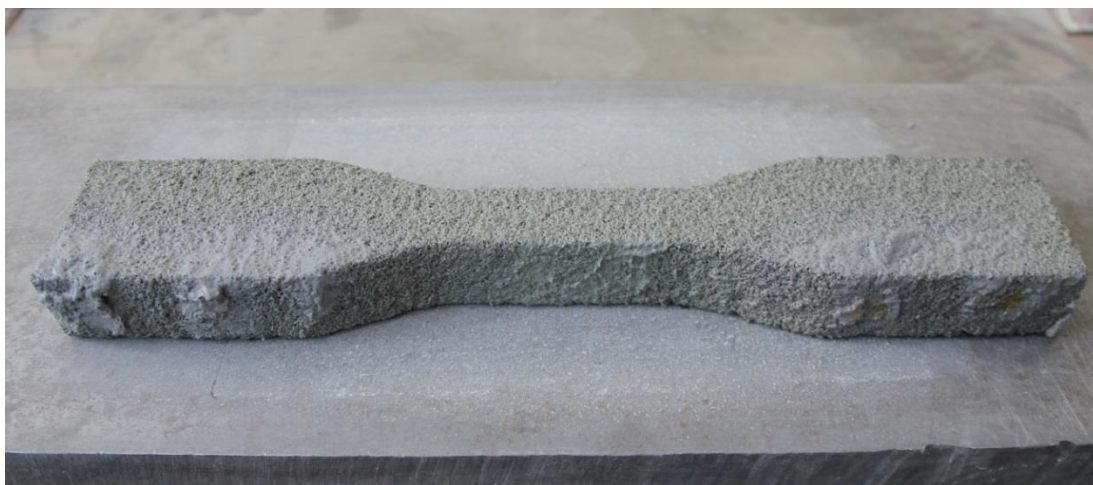
Obr. 29 - Vzorek vyjmutý z kyseliny sírové se zbytky cementového tmelu
