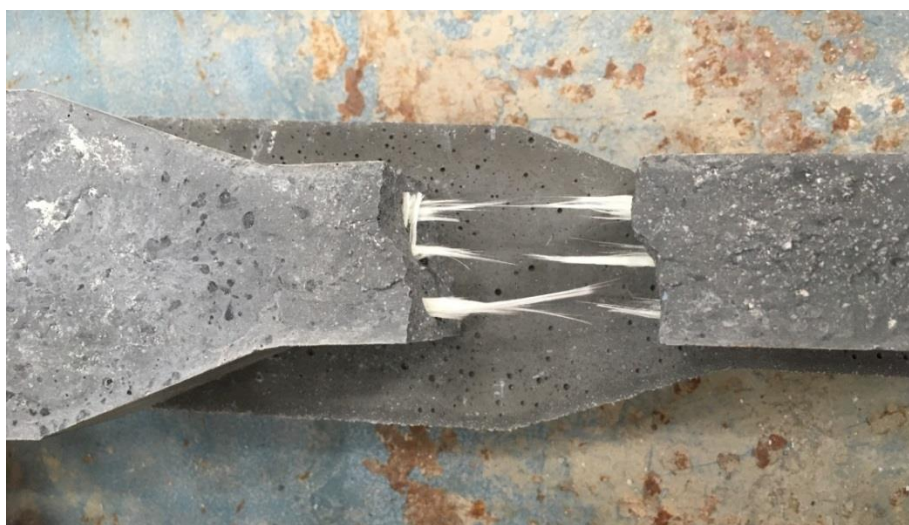
Obr. 32 - Roztržená vlákna výztuže R 585 A101
