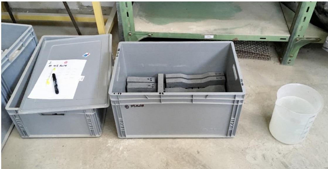
Obr. 25 - Vzorky v nádobě před nalitím roztoku a zapečetěním
