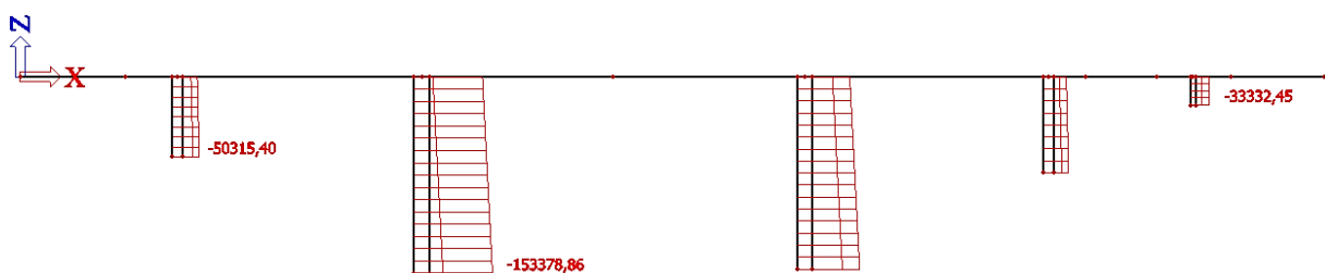
Obr. 29: Výstup ze statického programu – průběh normálových sil na rámových stojkách [kN]
