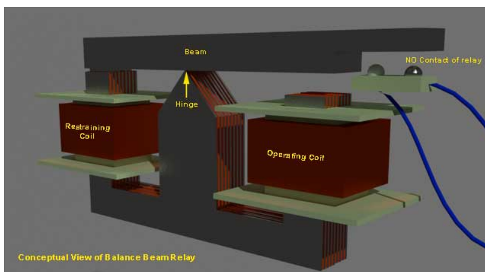
Obrázek 2.1: Relé s vyváženou kotvou [10]
