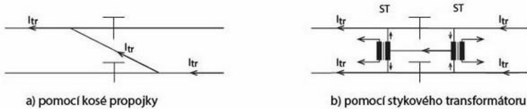
Obrázek 7 - Propojení izolovaných kolejnic, zdroj [6]
