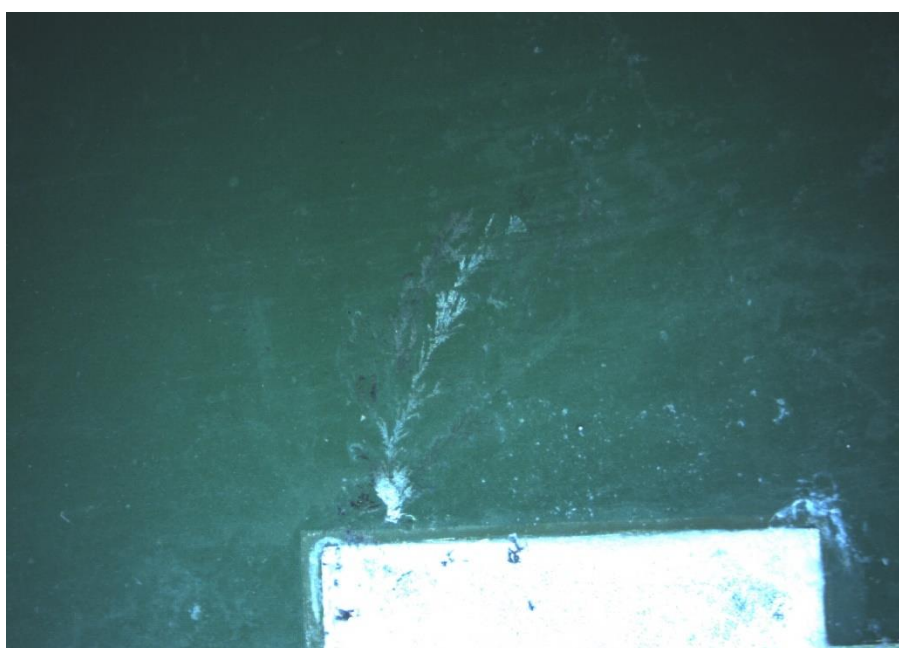
Obrázek 22 Pájecí pasta SAC, postříbřená povrchová úprava
