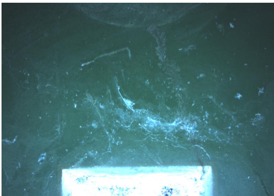
Obrázek 25 Pájecí pasta SAC, postříbřená povrchová úprava
