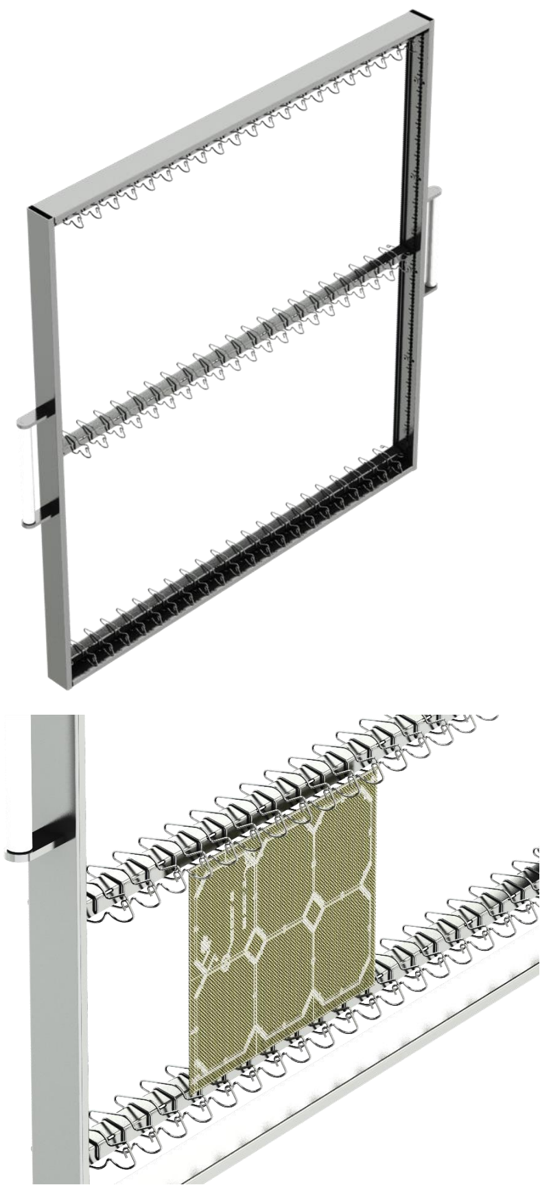
Obrázek 19 Ukázka rámu pro uchycení DPS uvnitř zařízení (nahore), detail uchycení DPS (dole)
