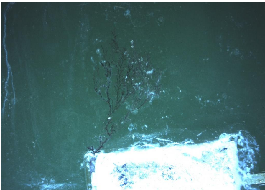
Obrázek 24 Pájecí pasta SAC, bez povrchové úpravy
