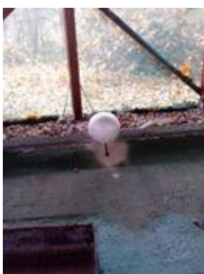
Obr. 5 Vřícovací bod, kulový terč
