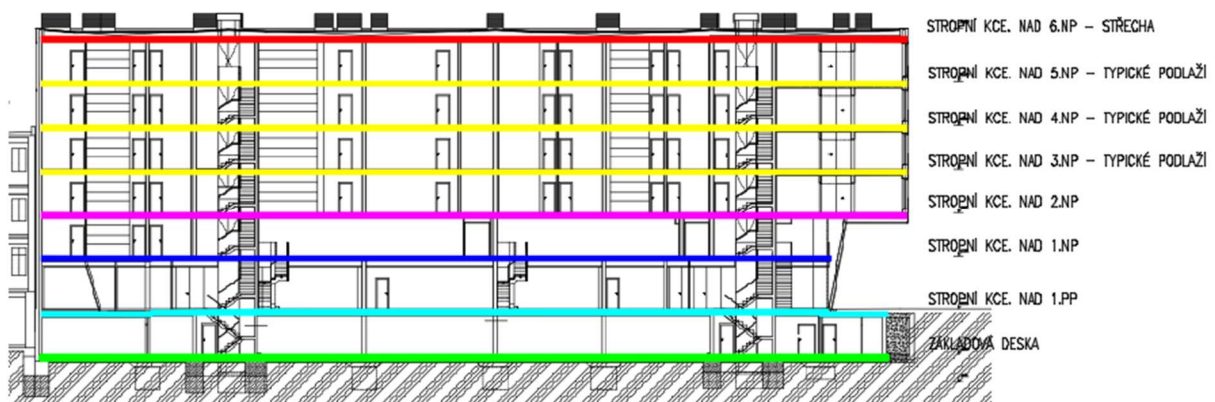
(Obr.23 – Schéma označení stropních konstrukcí polyfunkčního objektu)
