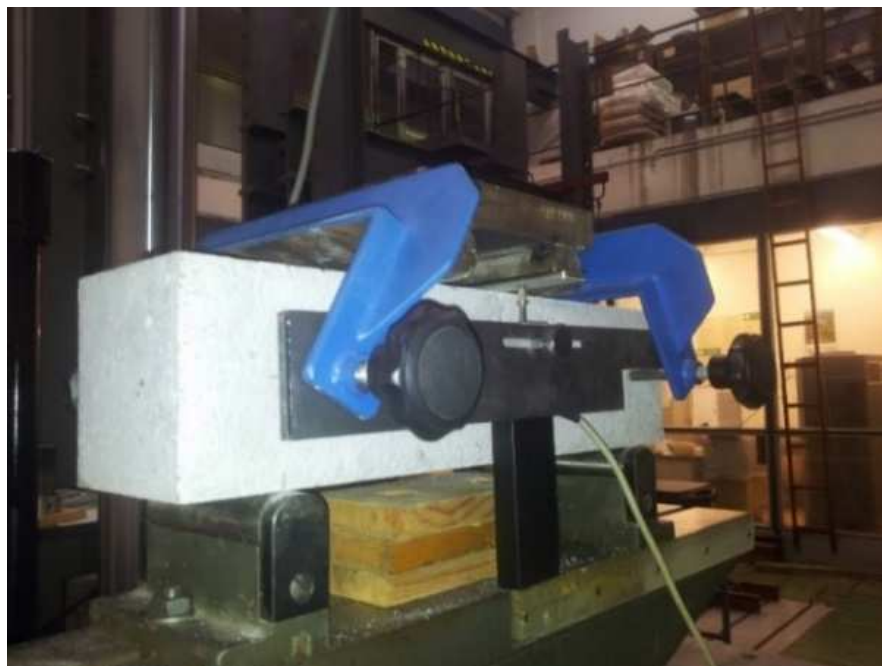
Obrázek 79- Zkouška ohybem na trémkách. [68]
