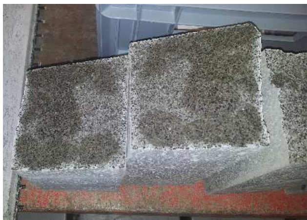
Obrázek 77- Vlhké skvrny na rozlomených vzorcích trámců. [68]
