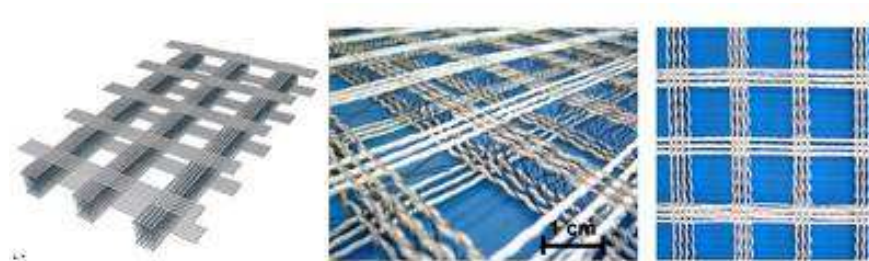
Obrázek 22-Textilní síť, "3D-Gitter". [31]
