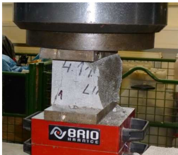
Obrázek 83- Zkouška v tlaku na zbytcích z trámců. [68]
