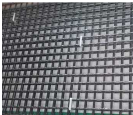
Obrázek 27- Textilní síť z uhlíkových vláken. [68]
