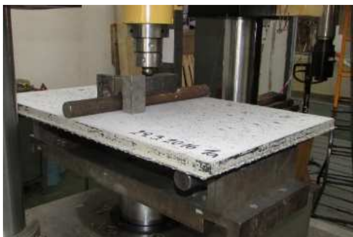
Obrázek 94- Zkouška tříbodovým ohybem, D1a. [68]
