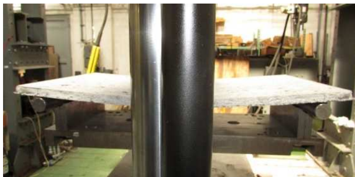
Obrázek 96- Viditelný průhyb desky při zkoušce tříbodovým ohybem, D1a. [68]
