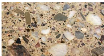
Obrázek 3- Řez prostým betonem. [7]
