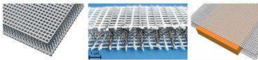
Obrázek 20-Textilní síť, "3D-Sandwich". [31]
