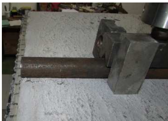
Obrázek 100- Viditelné podrcení betonu v místě zatížení při zkoušce tříbodovým ohybem, D1b. [68]
