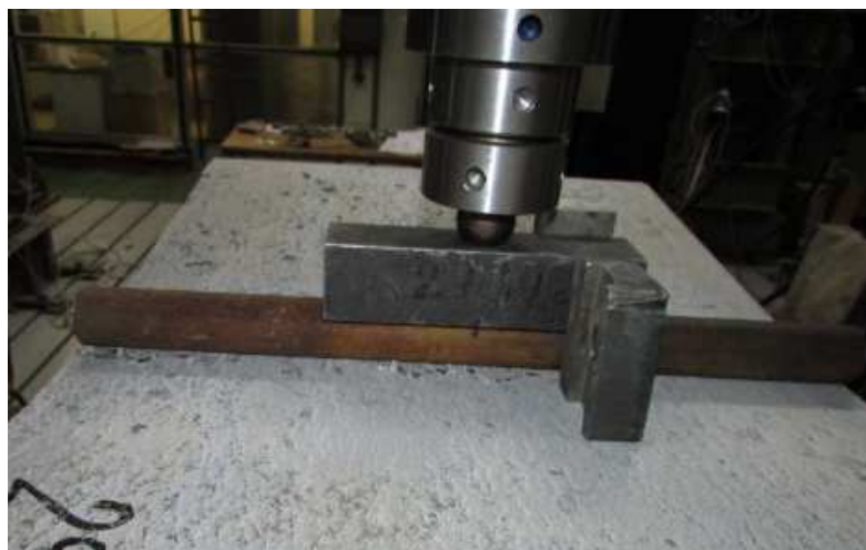
Obrázek 101- Viditelné podrcení betonu v místě zatížení při zkoušce třibodovým ohybem, D1b. [68]
