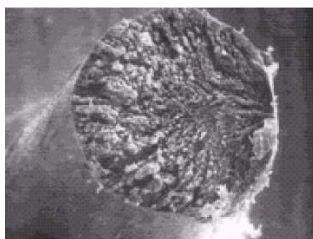
Obrázek 40- Granulární lom u lyocelových vláken. [44]
