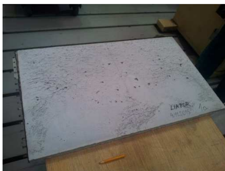
Obrázek 86- Jednostranně vyztužená deska před destruktivním zkoušením. [68]
