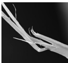
Obrázek 38- Axiální štěpení u aramidového vlákna- Kevlar. [44]
