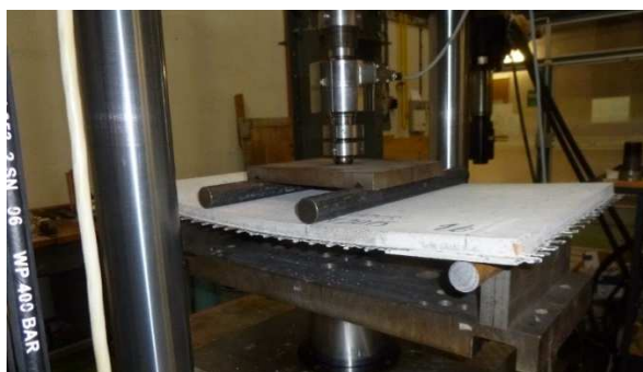
Obrázek 87- Jednostranně vyztužená deska během destruktivní čtyřbodové zkoušky. [68]
