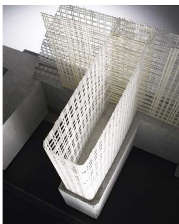
Obrázek 60 Textilbeton, skleněná výztuž mostu v Lautingen. [55]
