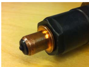
obr. č. 11.: Tryska s měděným pouzdem (převzato z [1])
