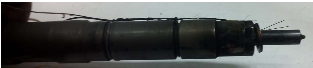
obr. č. 41.: Vstřikovač systému common rail s porušenými termodrátky.
