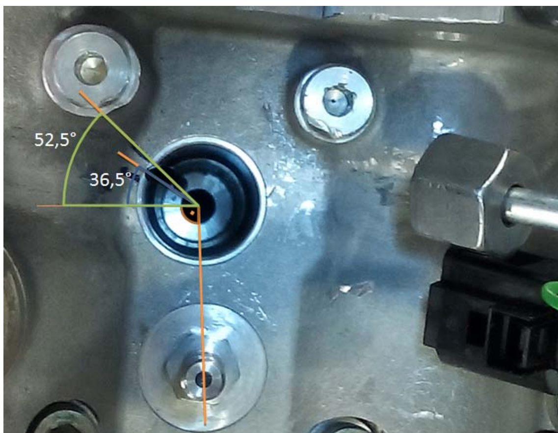
obr. č. 29.: Vyobrazení úhlů pro překreslení na vstřikovač, pod kterým je vytvořen prostor pro vedení termodrátků.
