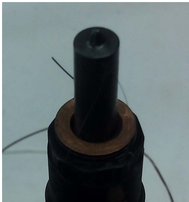
obr. č. 42.: Detail porušení termodrátků
