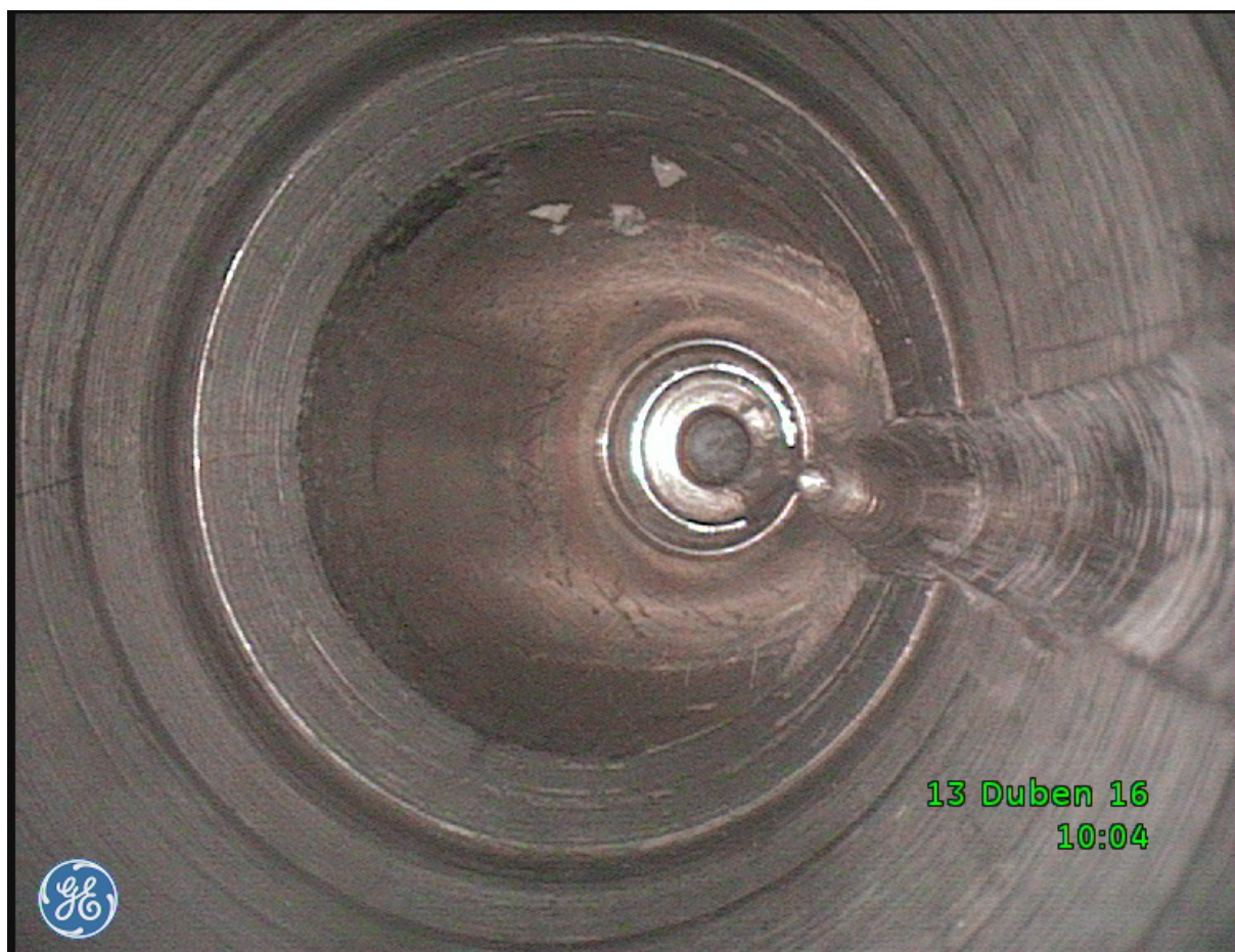
obr. č. 30.: Detail uložení vstřikovače s drážkou pro vývod termodrátků
