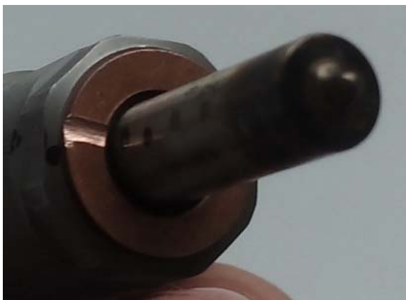
obr. č. 33.: Úprava tenkého měděného těsnění
