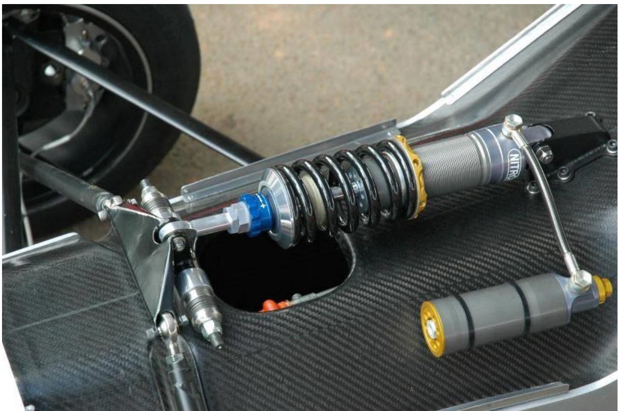
Obrázek 9 Odpružení typu monoshock na vozidle (zdroj: [22])
