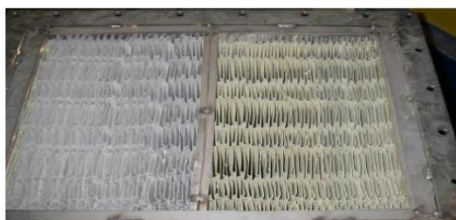
Obrázek 9 – Katalyzátor užívaný pro metodu High-Dust Zdroj [13]
