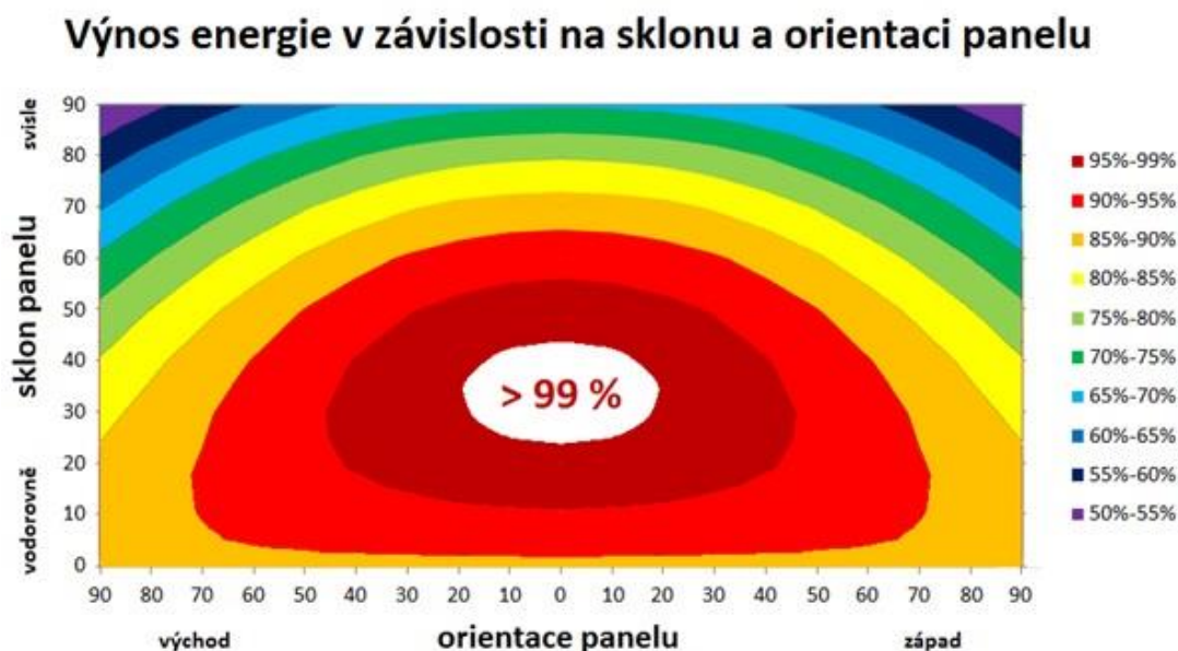
Graf 1: Výnos energie v závislosti na sklonu a orientaci FV panelu [6]
