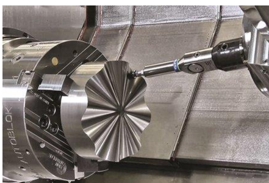
Obrázek č. 25: Ukázka práce speciálního nástroje pro vytvrzování v CNC stroji [38].
