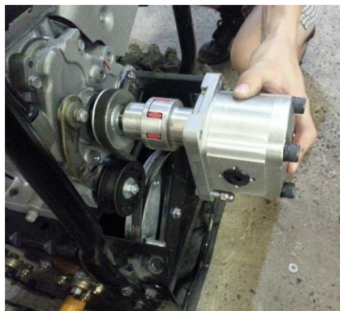
Obr. 35.: Spojení čerpadla s motorem (autor)
