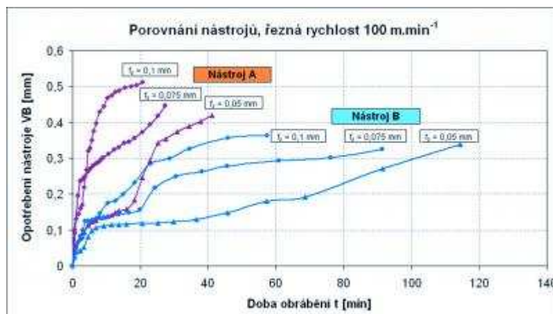
Obrázek 13 - Závislost opotřebení na době obrábění za sucha [19]
