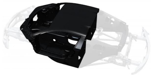
Obr. 9 Monocoque karosérii Bugatti Veyron [18]
