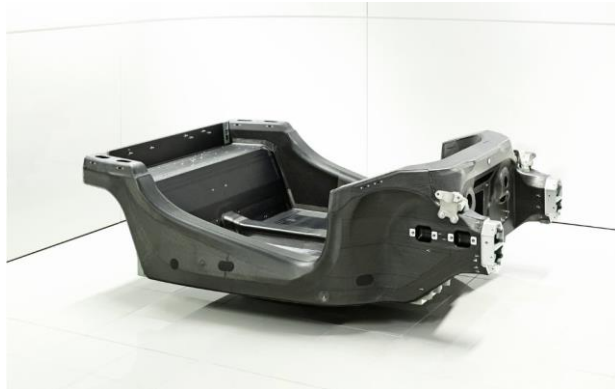
Obr. 8 Monocell šasi z uhlíkových vláken McLarenu 570S [17]
