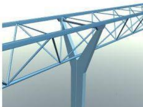
Obrázek 9. Kolejnice ve formě vazníku
