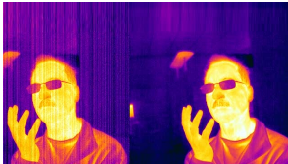
Obrázek 1.5: Vlevo je snímek bez aplikovaných korekcí signálu a vpravo je snímek po aplikaci vhodných algoritmů zpracování signálu v příslušných obvodech [4]
