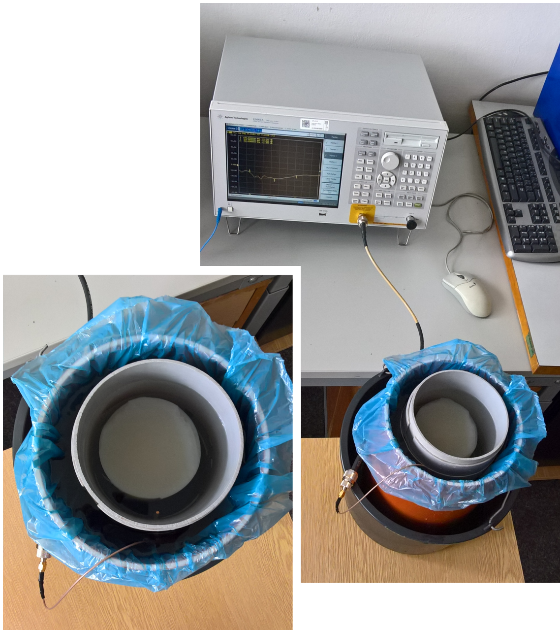
Obrázek 14: Měření modulu parametru s_{11} na jednodipólovém aplikátoru, zapojení.
