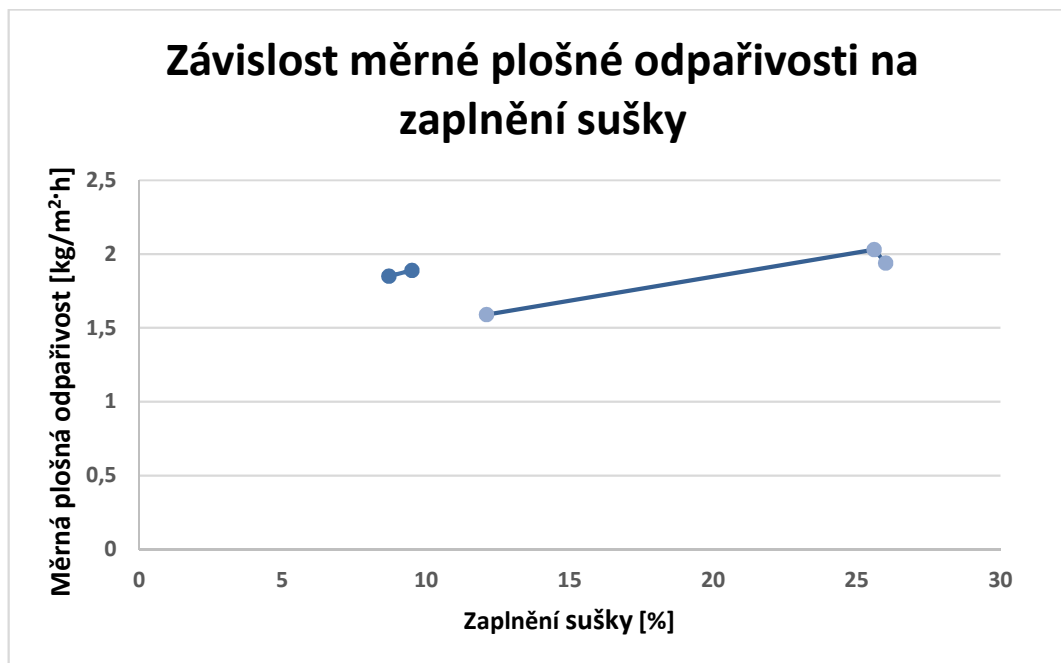
Obrázek 29 Závislost měrné plošné odpařivosti na zaplnění sušky
