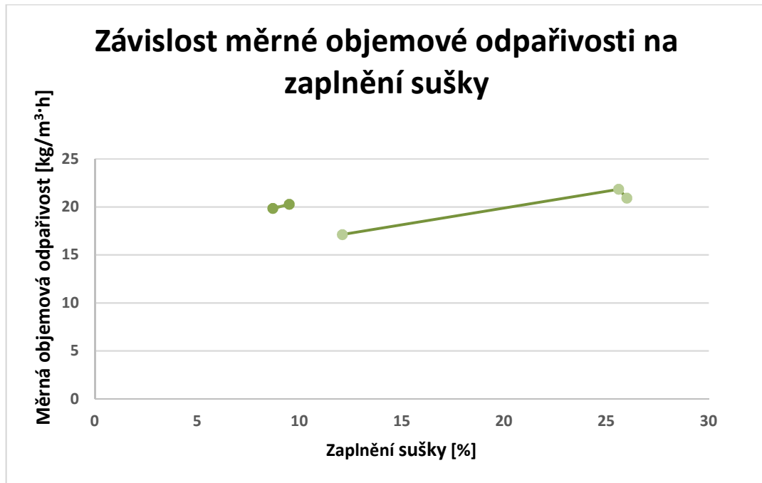
Obrázek 30 Závislost měrné objemové odpařivosti na zaplnění sušky
