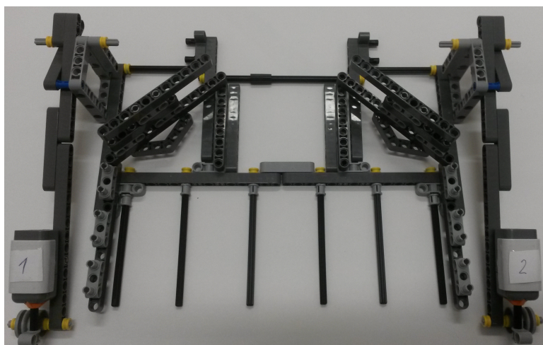
Obrázek 4.8: Sběrač míčků typu "hrábě"
