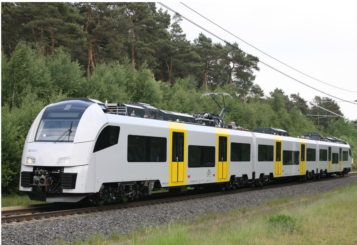
Obr. 5.1: Příklad moderní elektrické jednotky pro příměstskou regionální dopravu typu Desiro ML z produkce firmy Siemens. [48]
