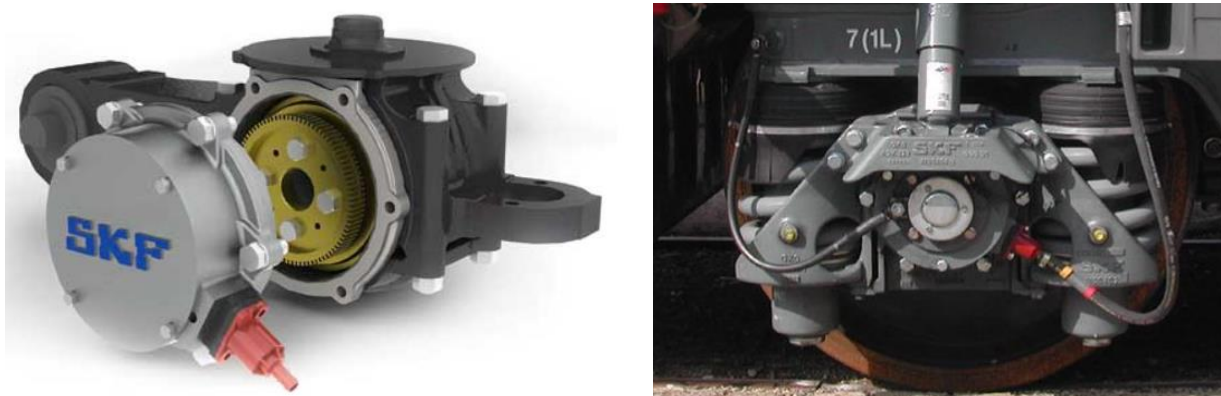
Obr. 3.2: Příklad provedení kontaktního odometru na nápravě vozidla od výrobce SKF. [42]
