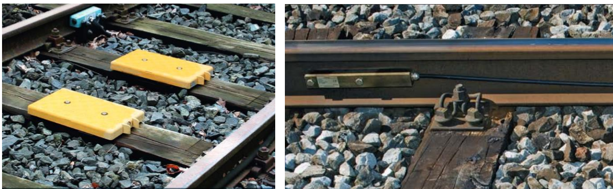
Obr. 3.1: Balízová skupina tvořená dvěma Eurobalise (vlevo) a kabel smyčky Euroloop umístěný v patě kolejnice (vpravo). [40]
