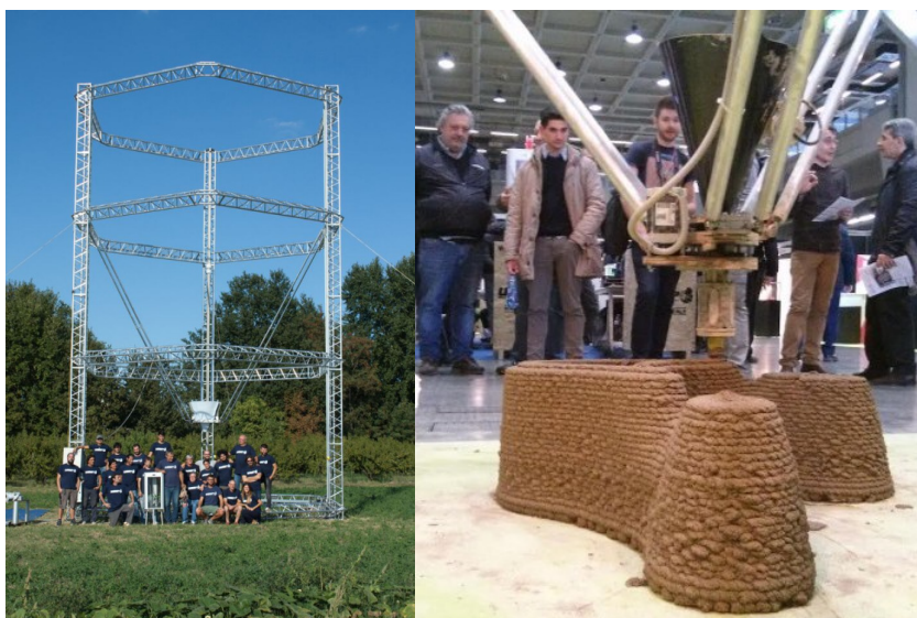
Obr. 21. : Vľavo vývojársky tím a tlačiareň Delta WASP, Vpravo triska v procese tlače. [32]
