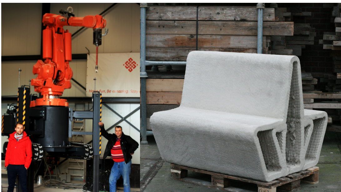
Obr. 16. Vľavo mobilný robot CyBe RC 3Dp. Vpravo lavička predávaná firmou Cybe [34]
