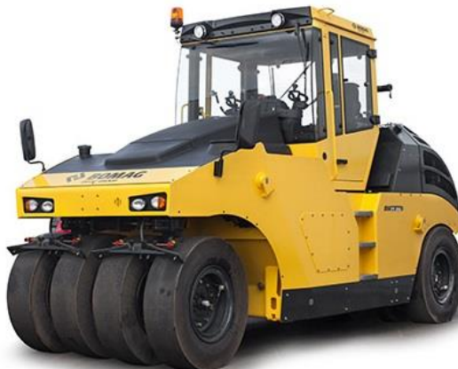
Obr.19 Pneumatikový válec BOMAG BW 27 RH-4i [50]
