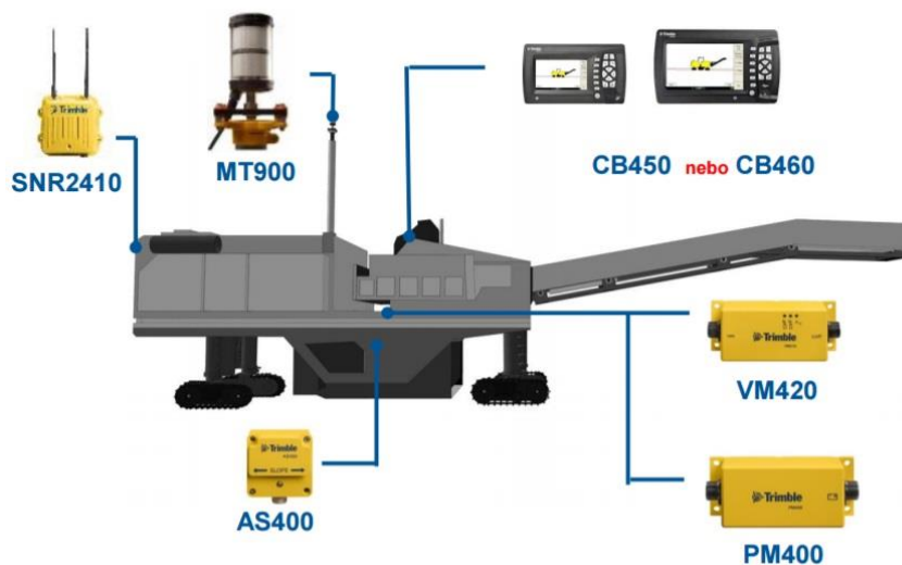
Obr.9 Komponenty systému PCS900 3D pro frézy [39]
