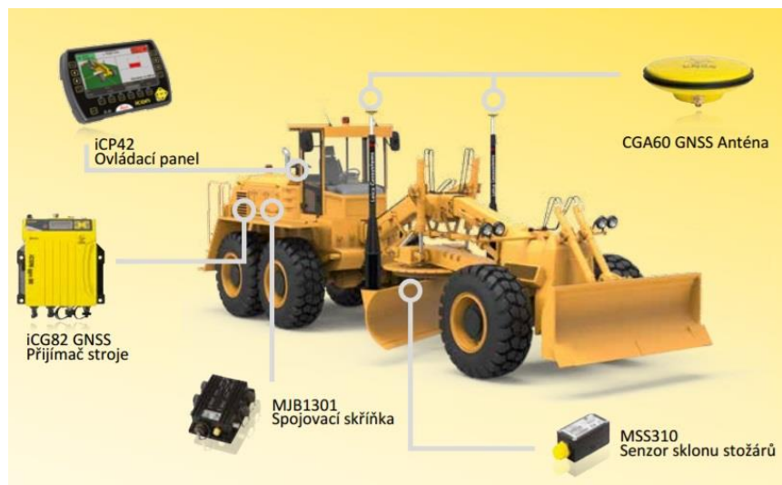
Obr.5 Komponenty iGG4 systému grejdru [29]
