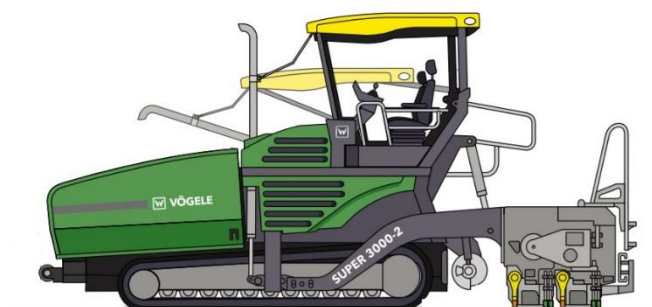
Obr.13 Asfaltový finišer VÖGELE SUPER 3000-2 [46]
