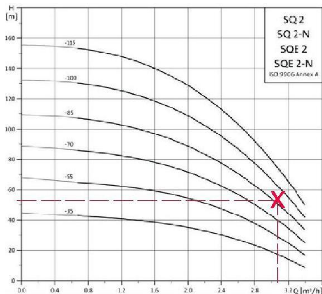
Obrázek 3. Graf výkonu čerpadla Grundfos SQ 2-100 [3]
