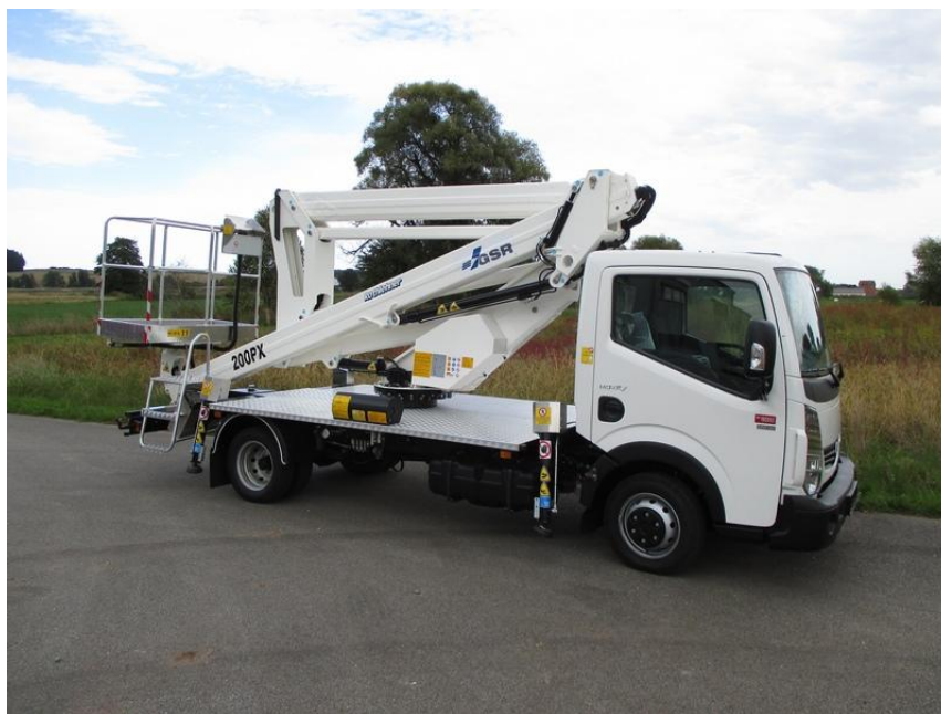
Obr. 31: Teleskopická plošina – E210THD (Převzato z [23])
