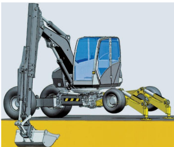
Obr. 36: Kaiser S2-3 – krácející rýpadlo (Převzato z [23])
