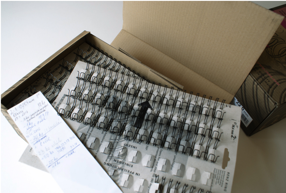
Obrázek 2.3: Většina materiálu je uskladněna na papírových platech v krabici. Drátěné hřbety snášejí i uskladnění na rolích většího průměru. Také je zde vidět ukázka evidenční karty, která je uskladněna spolu s materiálem.
