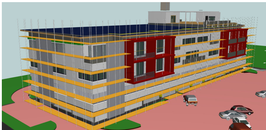
Obrázek 14 - Axonometrie z 1. zhotovené strany lešení na námi řešeném objektu.
