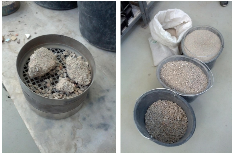
Obrázek č. 11 Průběh prosévací zkoušky recyklovaného kameniva a výsledný produkt – tři různé frakce kameniva
