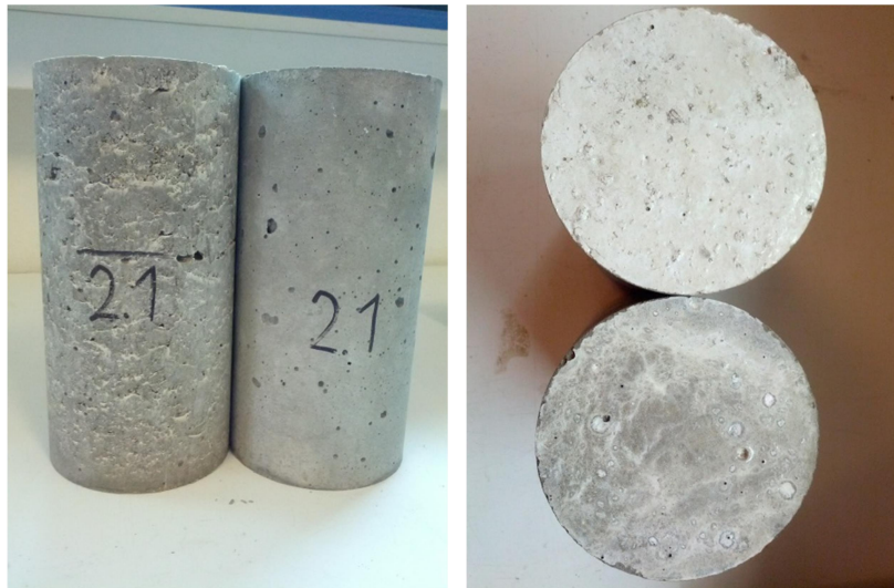
Obrázek č. 13 Rozdíly ve struktuře a barevnosti BPK (vpravo a dole) a BRK
