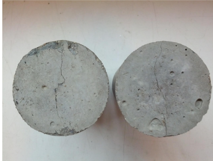
Obrázek č. 21 Prasklé vzorky č. 1 odbedněné po 18 hodinách
