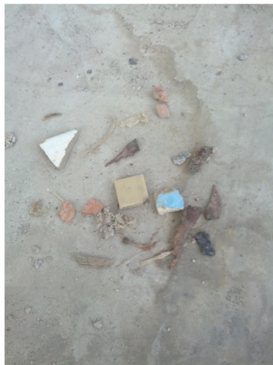
Obrázek č. 12 Kontaminující látky v recyklátu – identifikační test
