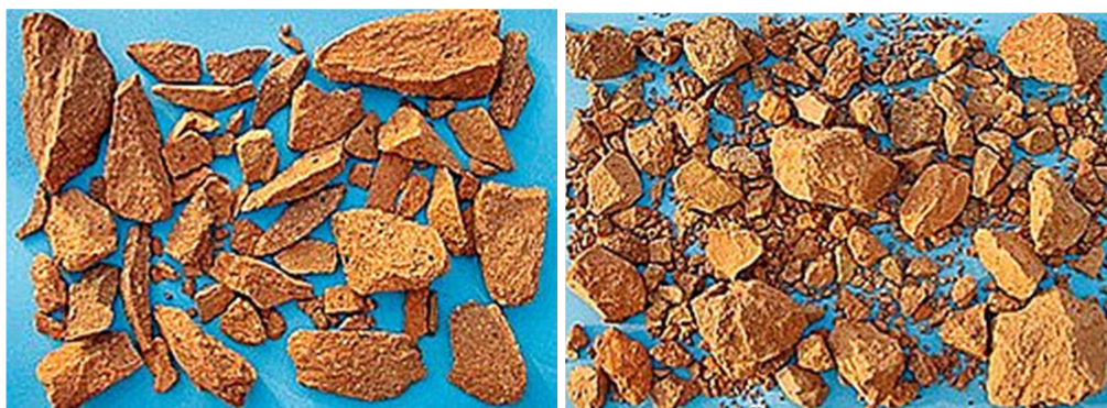
Obrázek č. 7 Typické tvary produktů po drcení čelistovým (vlevo) a odrazovým drtičem
