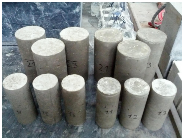
Obrázek č. 9 Čerstvě odbedněné vzorky č. 1 a 2 v 1. cyklu
