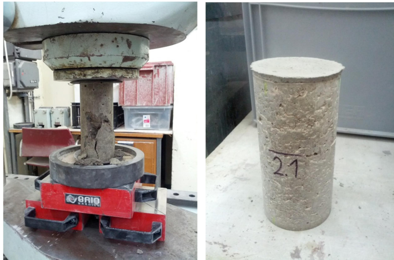
Obrázek č. 15 Zkouška válcové pevnosti vzorku č. 1 (stáří 20 hodin) a zakoncovaný vzorek č. 2 (stáří 28 dní)
