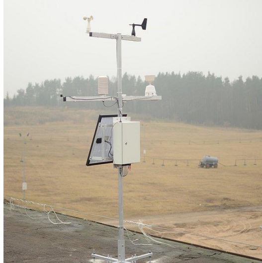
Obrázek 10 Meteostanice vybavená GSM modulem [7]
