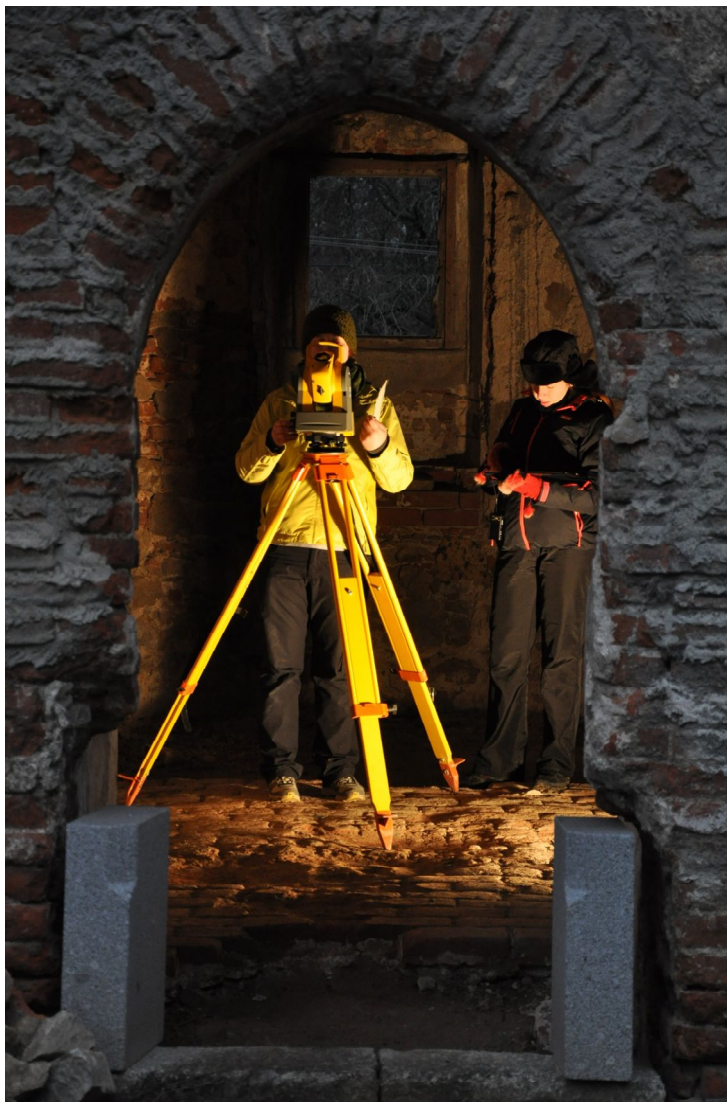
Obr. 6 Zaměření identických bodů, zdroj: Jindřich Hodač
