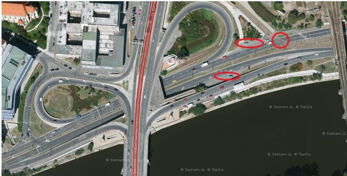
Obr. 21 – Letecký pohled s vyznačenými zastávkami MHD, křížením tramvaj s automobily a tramvajovým pásem, zdroj [18]
