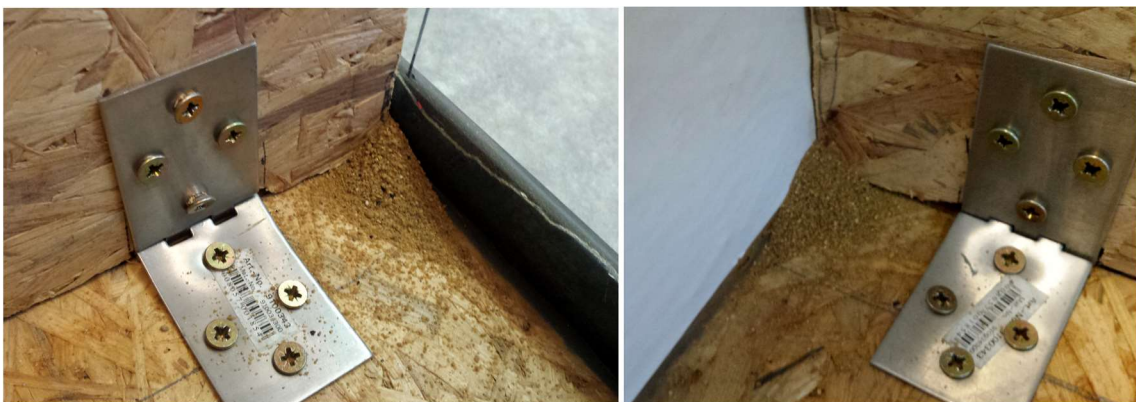
Obrázek 68 – Množství propadlého písku po třiceti cyklech mezi stěnou boxu a deskou opěry u modelu (2).
