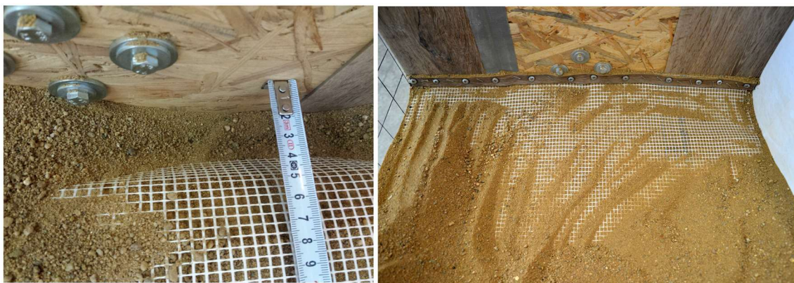
Obrázek 65 – Deformace výztuže zásypu po třiceti cyklech u modelů: a) (2); b) (3).
