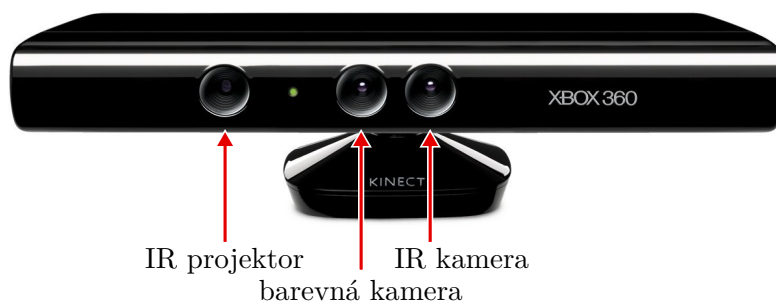
Obrázek 1.4: Popis zařízení Kinect, upraveno z [1]
