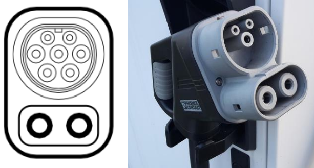
Obrázek 16 - Konektor na nabíjení elektromobilu-Combo2 [31]
