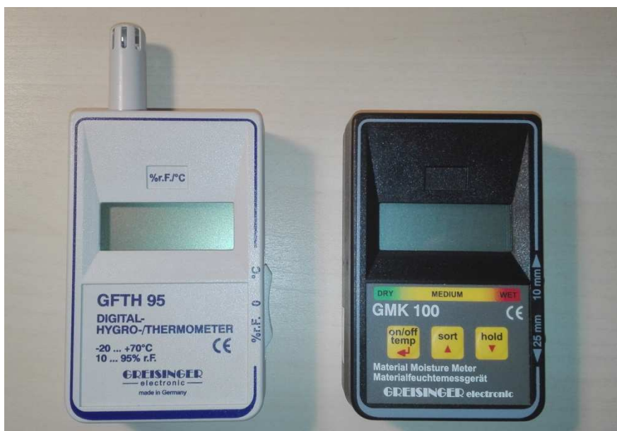
Obr. č.38 měřící přístroje vlhkoměr/teploměr GFTH 95 a vlhkoměr GMK 100
