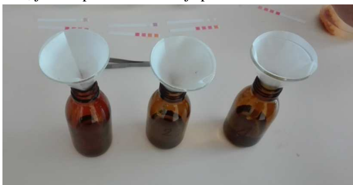
Obr. č. 42 filtrování solného roztoku od tuhých částí
