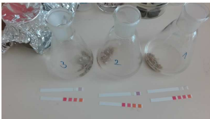
Obr. č.39 předběžný test na dusičnany a sírany pomocí proužků
