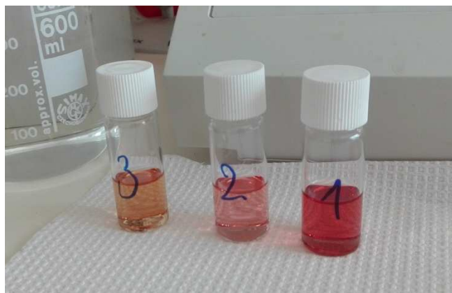
Obr . č. 44 zkumavky se vzorky připravenými na vyhodnocení ve fotometru na obsah dusičnanů
