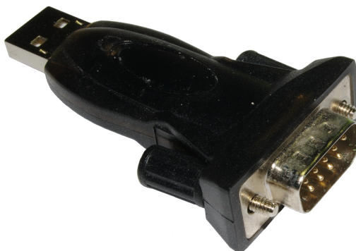
Obr. 4.1: Prevodník medzi USB 2.0 a RS-232 PremiumCord
