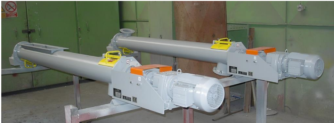
Obr. 46: Šnekový dopravník DELTA Engineering PSO 33 [55]
