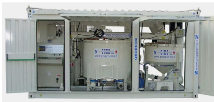
Obr. 41: Mísící centrum METAX – JM40PV [51]
