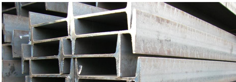
Obr. 6: Zápory tvořené z válcovaných I profilů [28]
