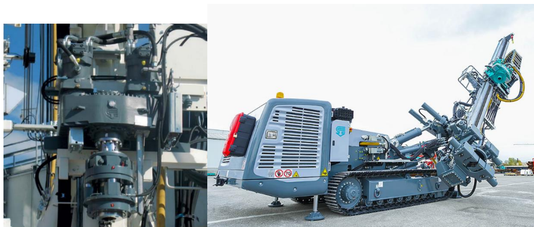
Obr. 37: Vrtná souprava pro tryskovou injektáž CASAGRANDE – C8XP [20]
