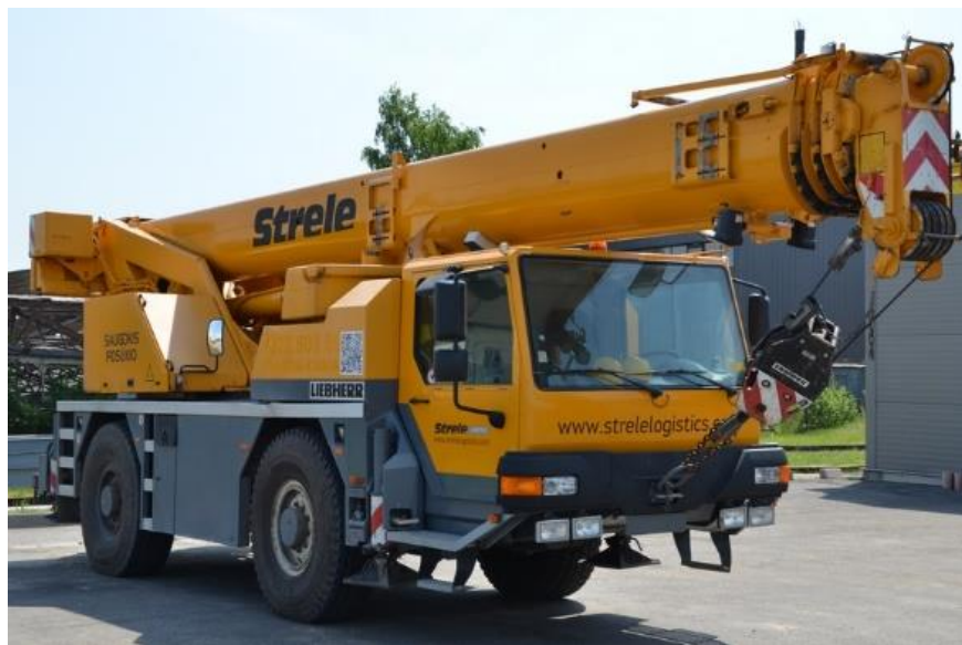
Obr. 50: Autojeřáb LIEBHERR LTM 1040 [57]
