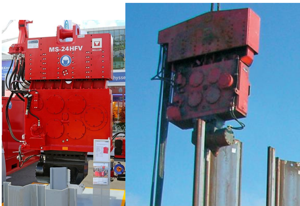
Obr. 48: Závěsné beranidlo MULLER MS – 20 HFV [36]
