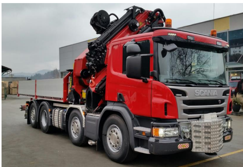
Obr. 58: Hydraulické rameno F1950RAL na automobilovém podvozku Scania G440 [25]
