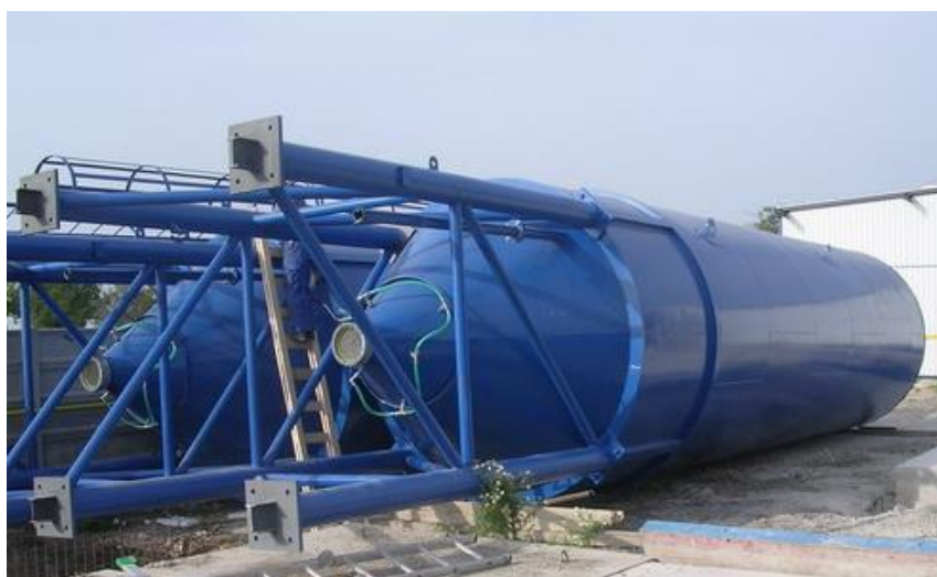
Obr. 44: Zásobník na cement ZC – 32 [53]
