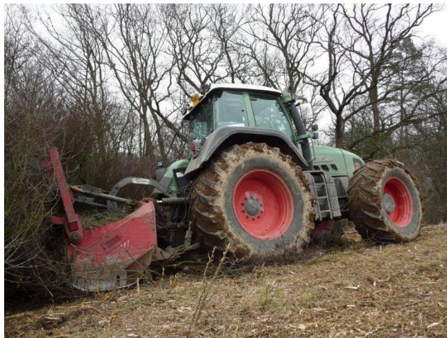
Obrázek 8: Likvidace pařezů a křovin pomocí mulčovací frézy
