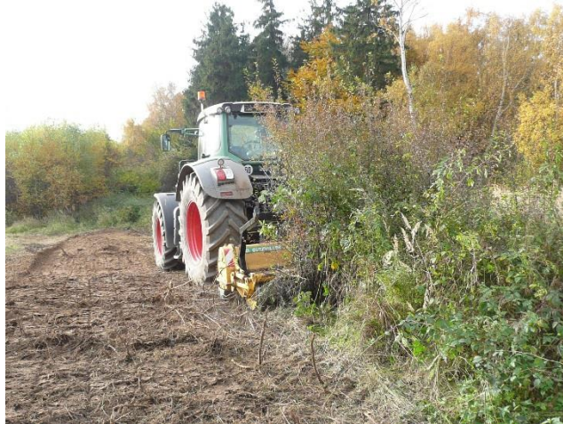
Obrázek 7: Likvidace kořenů a křovin pomocí drtiče
