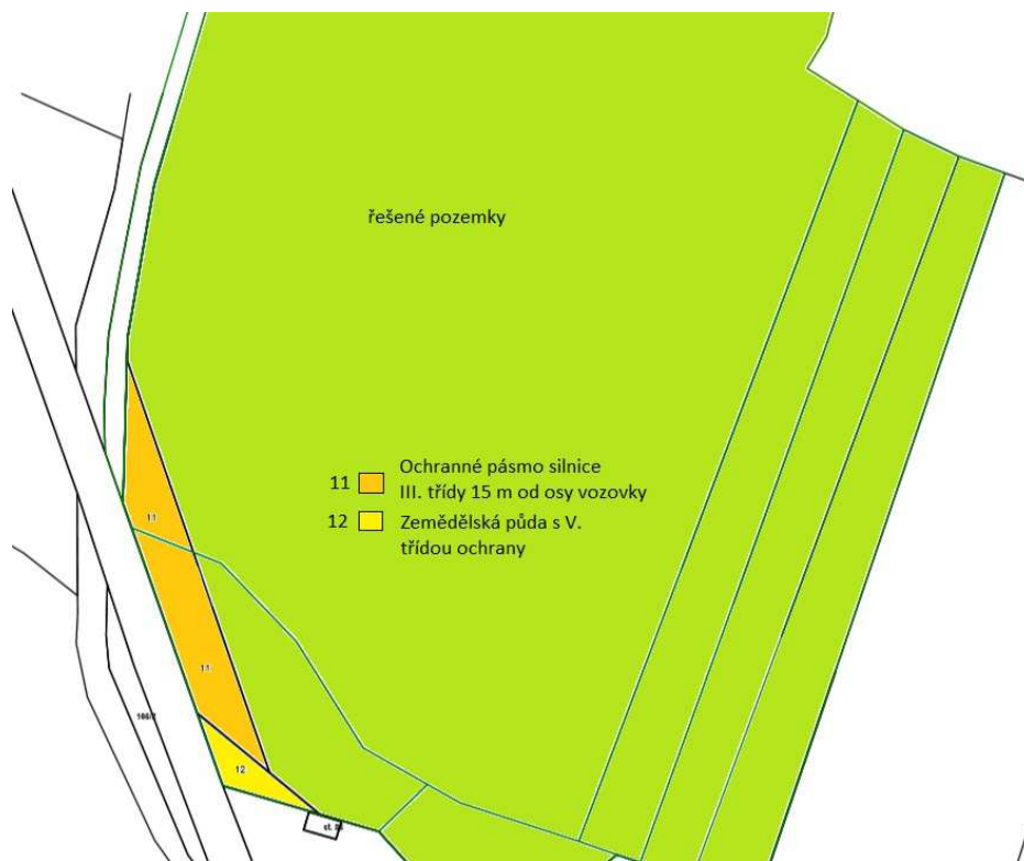
Obr. 4: Ochranná pásma nacházející se na řešených pozemcích
