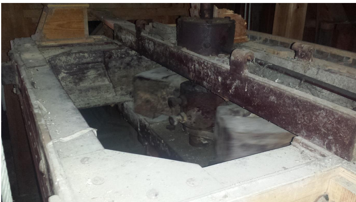
Excentr podávacího mechanizmu ve mlýně
