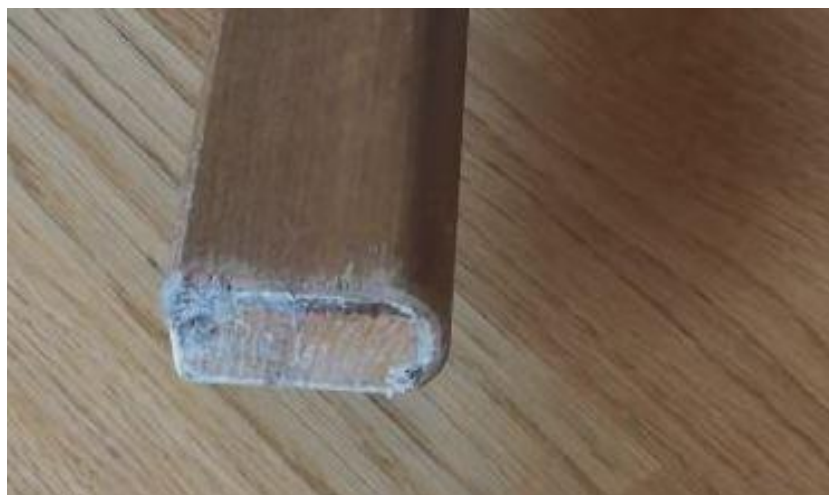
Obr. 25: Detail neošetřené nohy od židle – nános tvořený odřeným podlahovým lakem [35]
