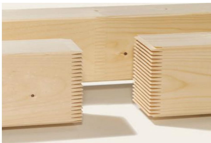
Obr. 7: Cinkový spoj KVH hranolu [47]
