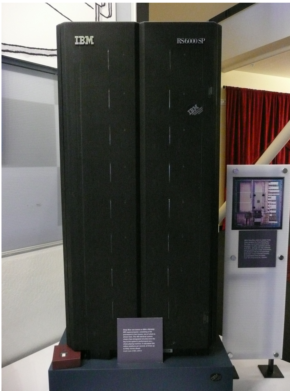
Obrázek 0.1: IBM Deep Blue superpočítač z roku 1997; volný překlad štítku: Deep Blue byl založen na superpočítači IBM RS/6000 SP2, skládal se z 30 procesorů ve dvou věžích, přičemž na obrázku je zobrazena jedna z nich. Klíčovým pro výkonnost celého systému bylo 480 na zakázku vyrobených čipů pro šachové výpočty.
