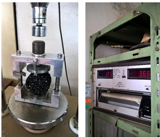
Obrázek č. 17 – Zatěžovací lis s umístěným Marshallovým tělesem (vlevo) [zdroj vlastní], Měřící zařízení (vpravo) [zdroj vlastní]
