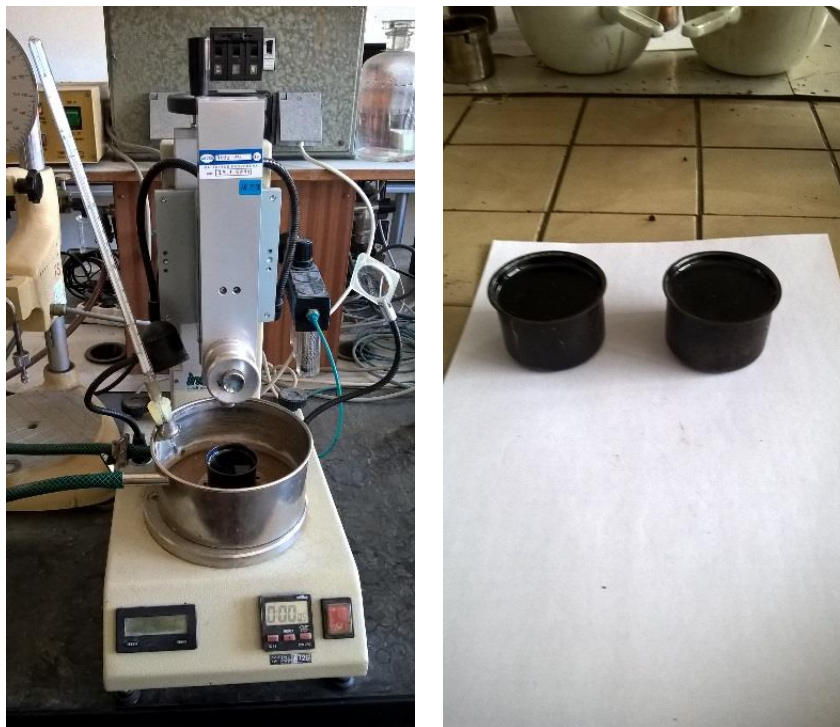
Obrázek č. 8 – Penetrometr s teploměrem a digitálním měřením hodnot vpichu (vlevo) [zdroj vlastní], vzorky pojiva připravené k provedení zkoušky (vpravo) [zdroj vlastní]
