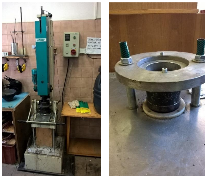
Obrázek č. 10 - Rázový zhutňovač s ocelovým podstavcem (vlevo) [zdroj vlastní], Výtlačné zařízení (vpravo) [zdroj vlastní]
