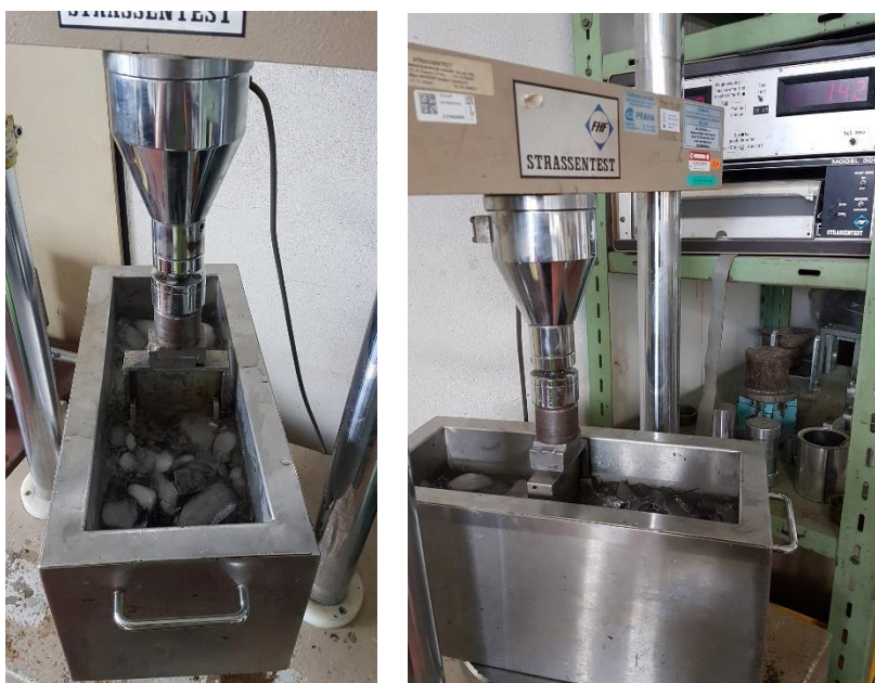
Obrázek č. 21 – Zkušební těleso umístěné do zatěžovacího zařízení (vlevo) [zdroj vlastní], Odečítání hodnot zatížení v průběhu zkoušky (vpravo) [zdroj vlastní]
