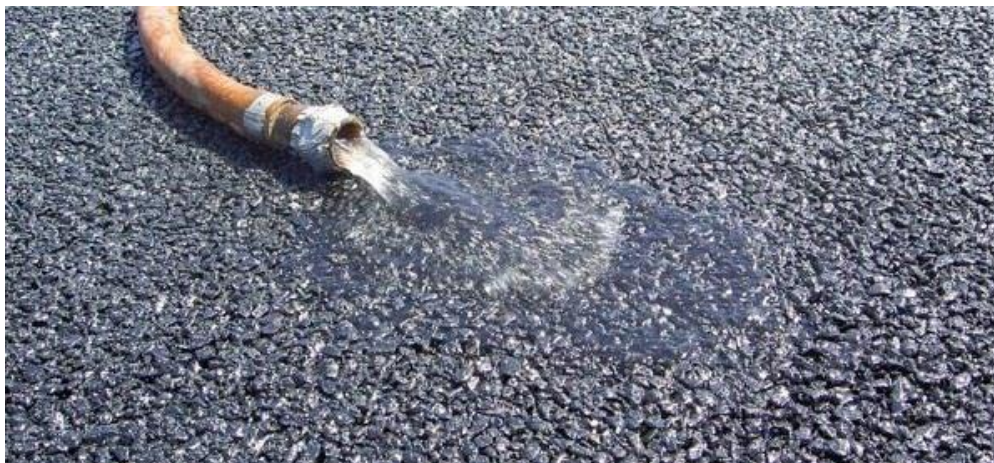
Obrázek č. 5 – Schopnost drenážního koberce odvádět vodu [2]
