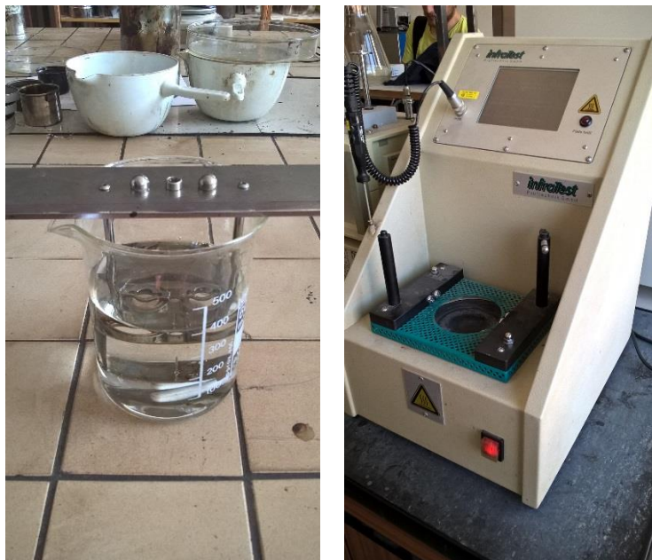
Obrázek č. 8 – Sestava ponořená do lázně v kádince (vlevo) [zdroj vlastní], zkušební zařízení pro kroužek a kuličku (vpravo) [zdroj vlastní]
