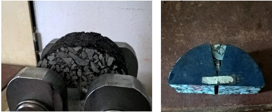
Obrázek č. 19 – Těleso ve zkušební zařízení (vlevo) [zdroj vlastní], Ověření platnosti zkoušky (vpravo) [zdroj vlastní]
