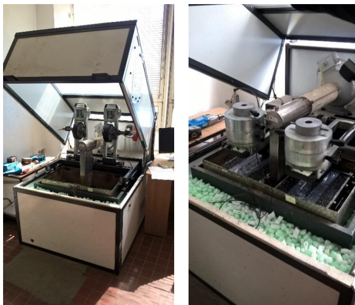
Obrázek č. 18 – Malé zařízení pro zkoušku pojíždění kolem (vlevo) [zdroj vlastní], Detail zařízení během zkoušky pojíždění kolem (vpravo) [zdroj vlastní]
