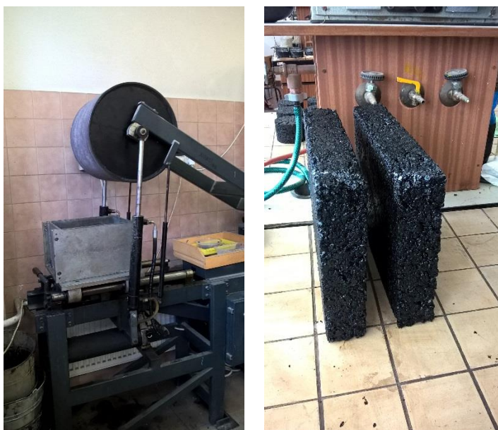
Obrázek č. 11 – Lamelový zhutňovač (vlevo) [zdroj vlastní], Vyrobená plošná tělesa (vpravo) [zdroj vlastní]
