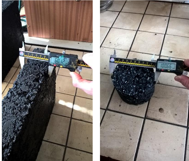
Obrázek č. 13 - Stanovení rozměrů desky (vlevo) [zdroj vlastní], Stanovení rozměrů Marshallova tělesa (vpravo) [zdroj vlastní]
