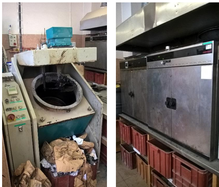
Obrázek č. 9 – Laboratorní míchačka (vlevo) [zdroj vlastní], Sušárna k nahřátí vstupních materiálů (vpravo) [zdroj vlastní]
