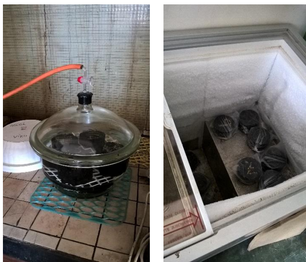
Obrázek č. 16 – Tělesa ve vakuové nádobě (vlevo) [zdroj vlastní], Tělesa při zahájení zmrazovacího cyklu (vpravo) [zdroj vlastní]
