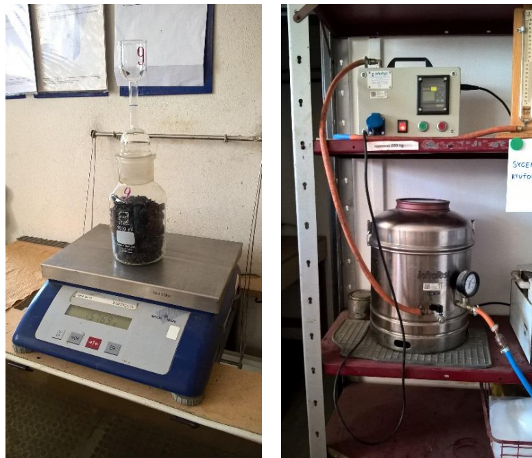
Obrázek č. 14 – Stanovení hmotnosti pyknometru s vysušeným vzorkem (vlevo) [zdroj vlastní], Vývěva s manometrem k odvzdušnění pyknometru (vpravo) [zdroj vlastní]
