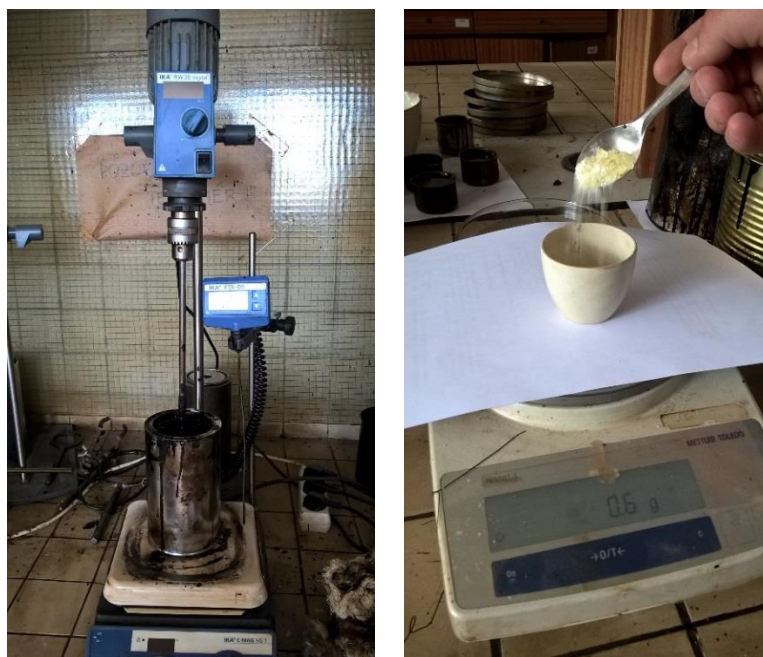
Obrázek č. 7 – Laboratorní míchadlo (vlevo) [zdroj vlastní], navážení přesného množství modifikátoru (vpravo) [zdroj vlastní]
