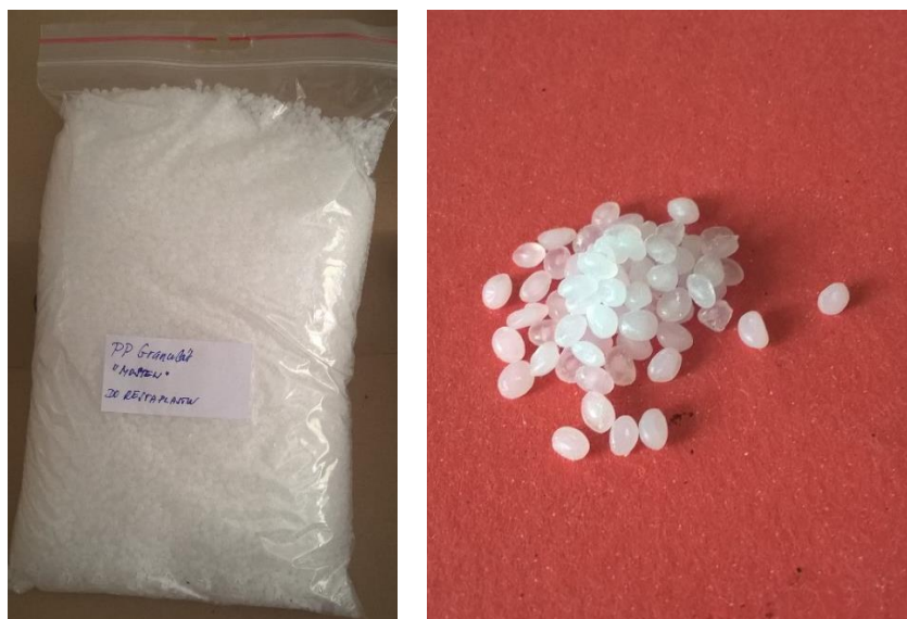
Obrázek č. 2 – PP Mosten MT 230 (vlevo) [zdroj vlastní], Konzistence použitého polymeru PP Mosten MT 230 (vpravo) [zdroj vlastní]
