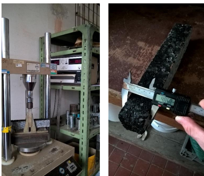
Obrázek č. 20 – Trámek při zkoušce tahu za ohybu (vlevo) [zdroj vlastní], měření rozměrů zkušebního tělesa (vpravo) [zdroj vlastní]
