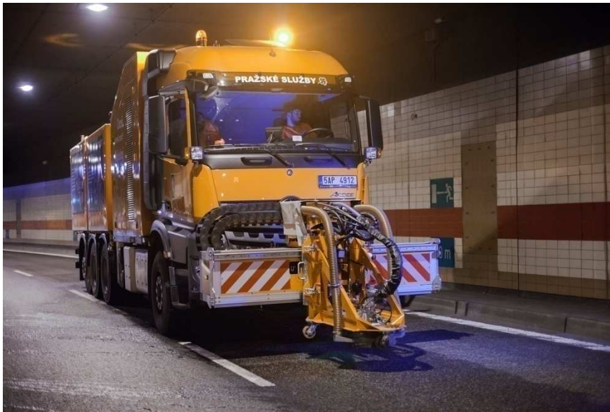
Obrázek 25: Technologie Peel Jet (tunel Mrázovka)
