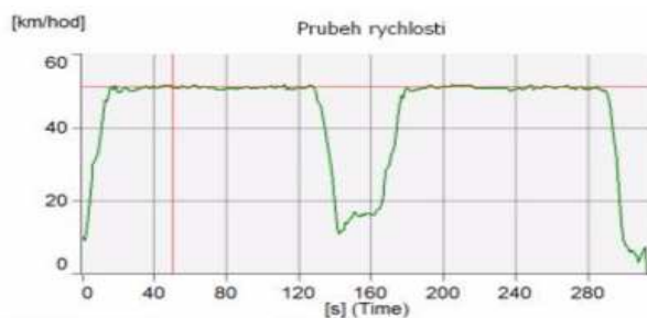
Obrázek 9: Průběh rychlosti, hladiny akustického tlaku a teploty povrchu na měřeném úseku v čase metodou CPX
