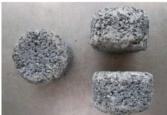
Obrázek 14: VIAPHONE® – zkušební tělesa po zkoušce ztráty částic
