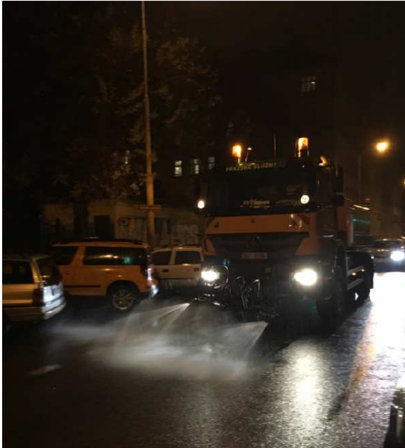
Obrázek 24: Plošné spláchnutí vozovky čistou vodou
