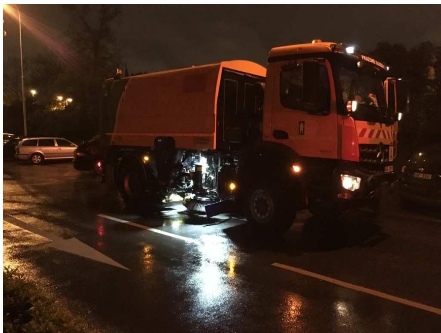
Obrázek 22: Samosběrná nástavba se speciálním vysokotlakým systémem mytí Faun Viajet na podvozku Mercedes Benz
