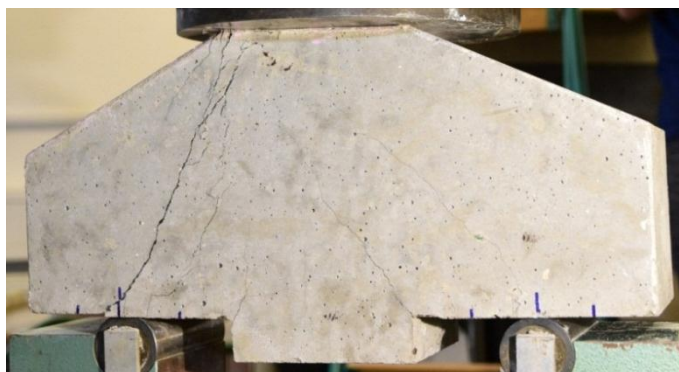
Obr. 5.26.: První trhliny ve vzorku vyztuženého betonářskou výztuží
