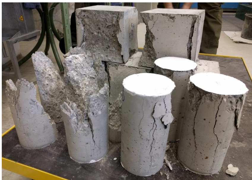
Obr. 5.23.: Porušená zkušební tělesa válců a krychlí
