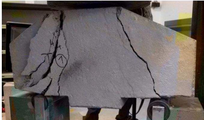
Obr. 5.28.: Zdeformovaný vzorek vyztužený betonářskou výztuží
