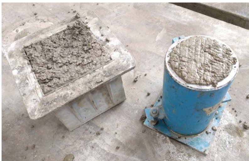
Obr. 5.15.: Plnění forem krychle a válce a hutnění na vibračním stole
