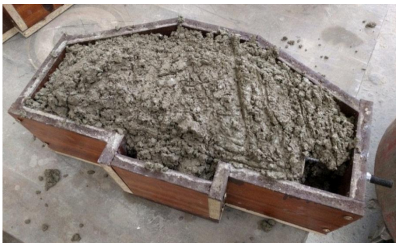
Obr. 5.13.: Plnění bednění předpjatých vzorků a hutnění na vibračním stole
