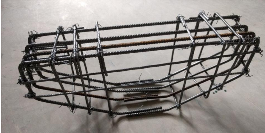
Obr. 5.8.: Svázaná výztuž do nepředpjatých vzorků
