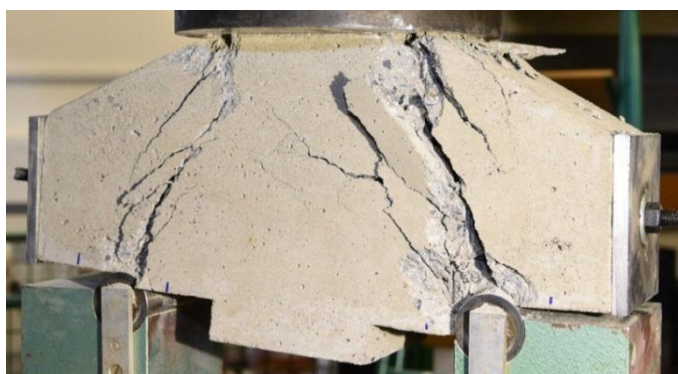
Obr. 5.32.: Zdeformovaný vzorek vyztužený předpjatou výztuží
