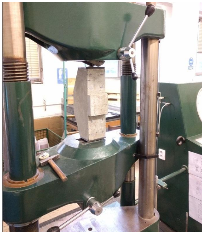
Obr. 5.18.: Předpínání závitové tyče v jednoosé trhačce
