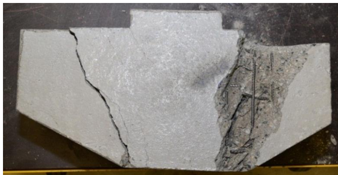
Obr. 5.30.: Zdeformovaný vzorek vyztužený betonářskou výztuží
