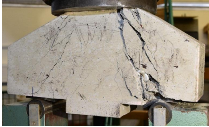
Obr. 5.27.: Zdeformovaný vzorek vyztužený betonářskou výztuží
