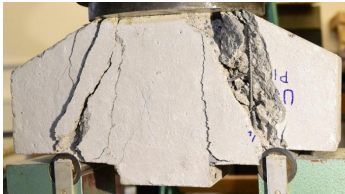
Obr. 5.29.: Zdeformovaný vzorek vyztužený betonářskou výztuží
