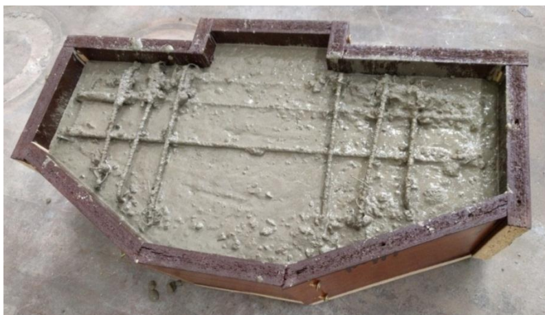
Obr. 5.14.: Plnění bednění nepředpjatých vzorků a hutnění na vibračním stole
