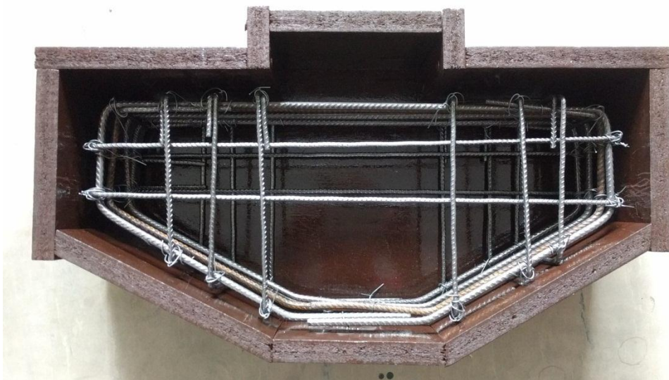
Obr. 5.9.: Svázaná výztuž do nepředpjatých vzorků a osazená v bedně
