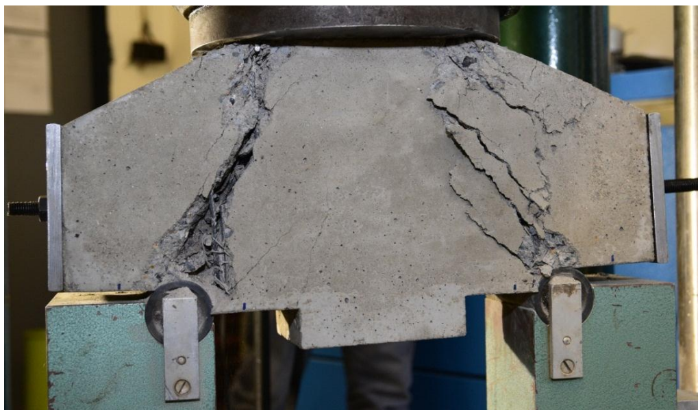
Obr. 2.1.: Zatěžování modelu krátké dvojkonzoly
