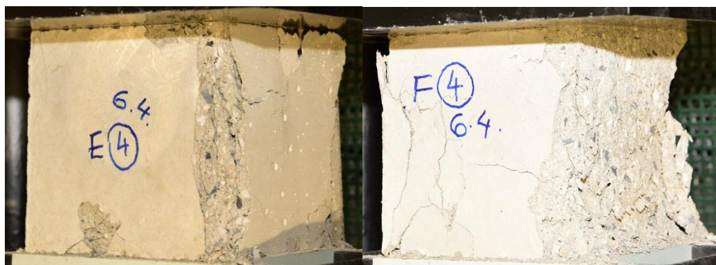
Obr. 5.22.: Porušená zkušební tělesa krychlí
