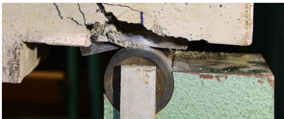
Obr. 5.24.: Zdeformovaná roznášecí deska
