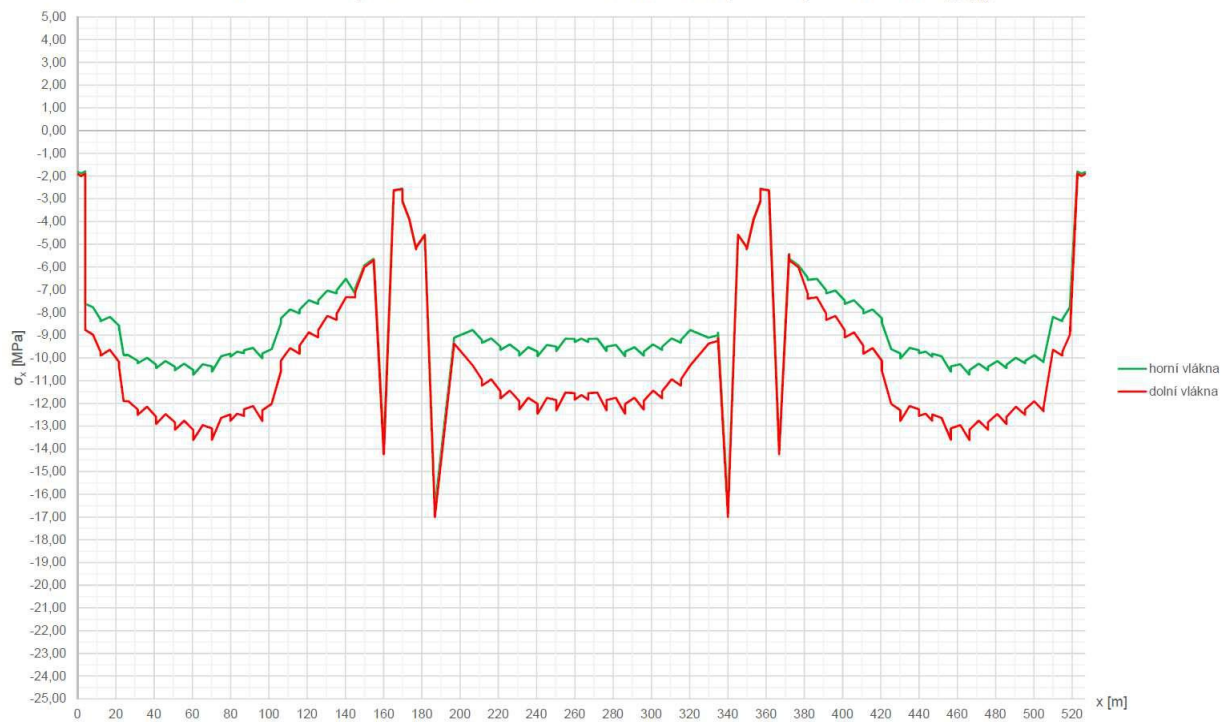
Normálové napětí od stálého zatížení - čas uvedení do provozu před vnesením (g-g_0)
