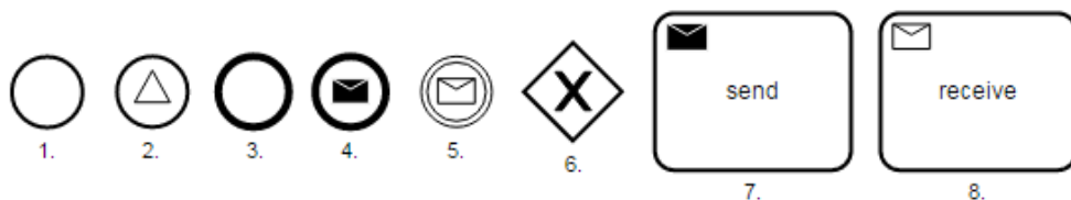
Obrázek 4.2: Specifické elementy BPMN použité při modelování procesů.
