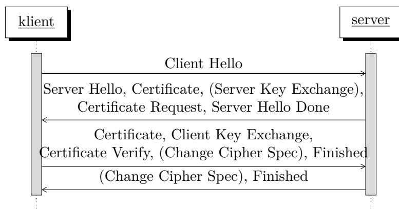
Obr. 1.16: Sekvenčný diagram nadväzovania TLS spojenia
