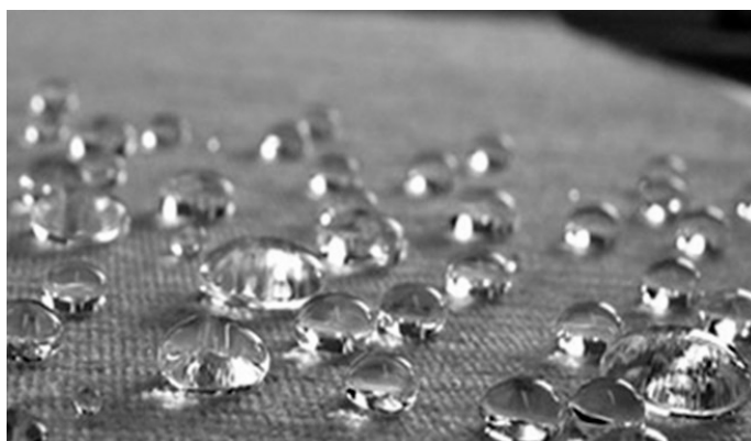
Obr. 6.10 – Impregnovaný povrch zabraňující vniknutí kapaliny. Kapalina se na povrchu vysráží ve formě malých kapek. [44]
