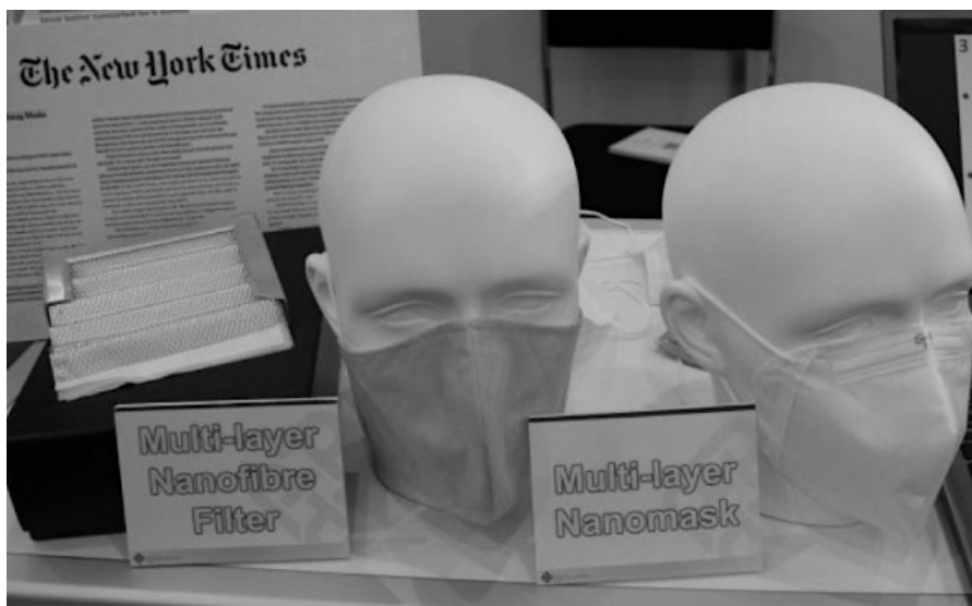
Obr. 7.11 – Použití vícevrstvého filtračního materiálu obsahující vrstvu nanovláken v případě ochranných masek vyvinutých na Hong Kong Polytechnic University. [64]
