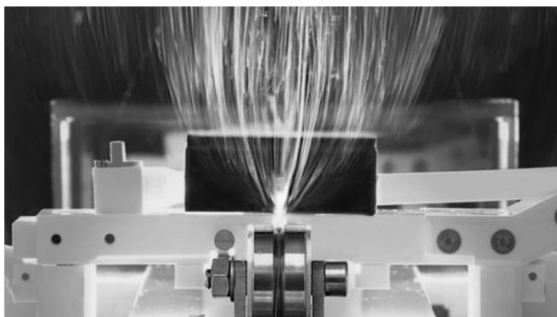
Obr. 7.7 - Reálná aplikace roztoku polymerů při tvorbě nanovláken v případě metody nanospider od výrobce Elmarco. [52]
